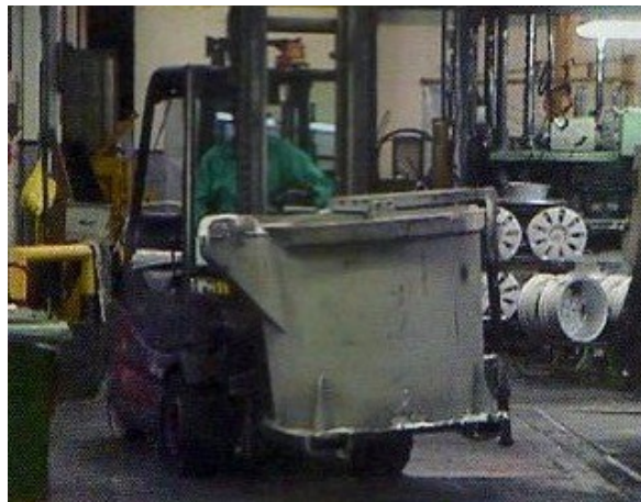
Figura 2.14 – Movimentazione delle siviere tramite muletto all'interno degli ambienti di fonderia.
