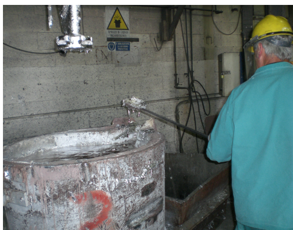
Figura 2.13 – Asportazione della scoria superficiale al termine del degasaggio.
