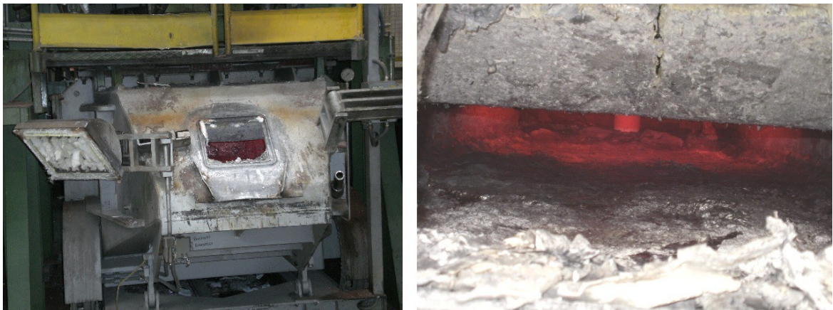
Figura 2.21 – Forno di mantenimento a bacino. Tutti i cerchi analizzati nella parte sperimentale della tesi sono stati colati in macchine di bassa pressione dotate di forni di questo tipo.
