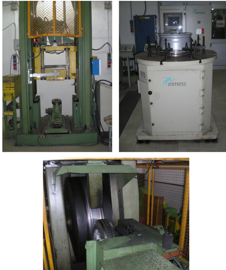
Figura 2.8 – In alto a sinistra, macchina per il test d'impatto; in alto a destra macchina per la prova di flessione rotante. In basso test di rotolamento in corso di svolgimento.
