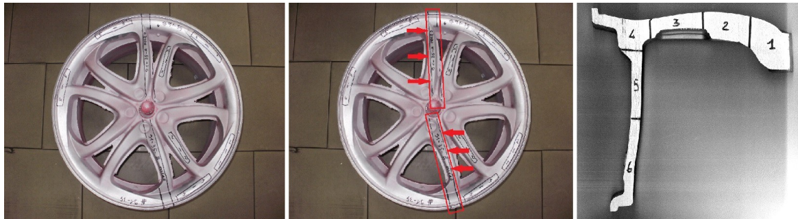
Figura 3.4 – A sinistra: cerchio # 13-91-35. Al centro: le frecce indicano le superfici delle sezioni successivamente lucidate per le analisi. A destra una sezione tracciata per essere suddivisa in ulteriori 6 zone. La zona n° 1 corrisponde al mozzo; le zone n° 2, 3 sono ricavate sulla razza; la n° 4 è rappresentativa del bordo esterno; le zone n° 5, 6 dividono il canale in due parti di lunghezza simile.
