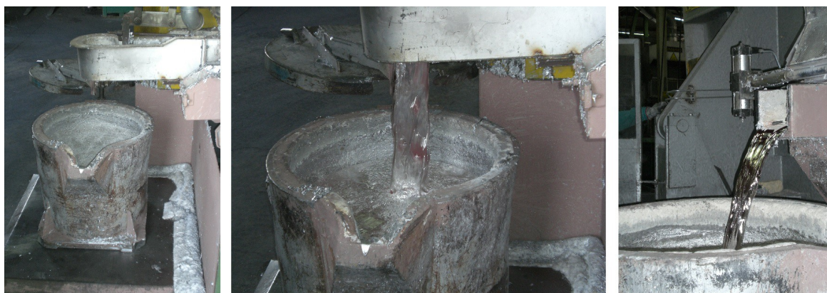
Figura 2.11 – All'estrema sinistra, siviera in posizione pronta per lo spillaggio della lega; al centro e a destra, operazione di spillaggio da forno fusorio.
