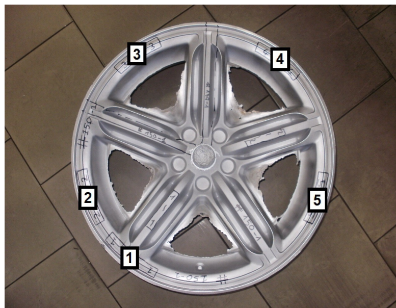
Figura 4.83 – Numerazione delle posizioni del bordo esterno del cerchio F. F. SL 2159; la classificazione dei dati di resistenza e difettologici in tabella 4.44 segue quanto riportato in questa immagine.
