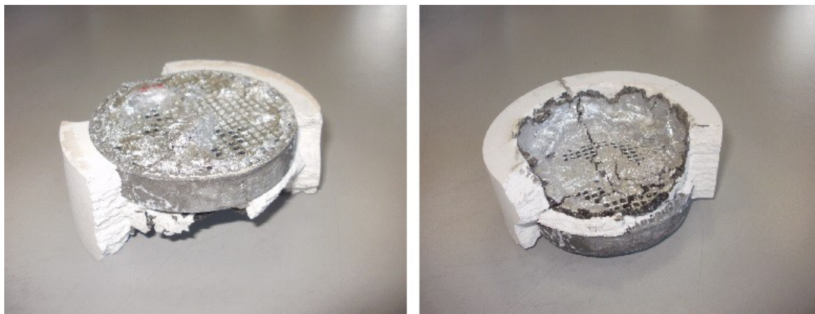
Figura 2.25 -Convogliatore di flusso in materiale ceramico dopo il termine della vita utile in macchina. A sinistra, lato inferiore; a destra lato superiore. Si notino i frammenti di alluminio e scoria i quali hanno ostruito parzialmente la sezione di passaggio verso l'ingresso della cavità stampo. E' visibile inoltre in entrambe le immagini la magliatura più ampia rispetto al filtro metallico.
