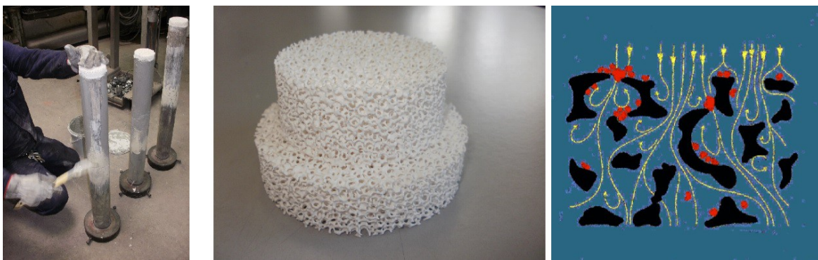
Figura 2.22 – Nell'immagine a sinistra, deposizione di vernice refrattaria durante la manutenzione di un tubo di alimentazione. Al centro, il filtro a spugna ceramica presente su tutte le macchine di bassa pressione all'estremità inferiore del tubo di alimentazione. A destra schema dell'azione di filtraggio: il lavoro di setaccio iniziale trattiene le inclusioni più grosse; la struttura interna, facendo variare direzione e velocità del flusso, blocca le particelle più fini.
