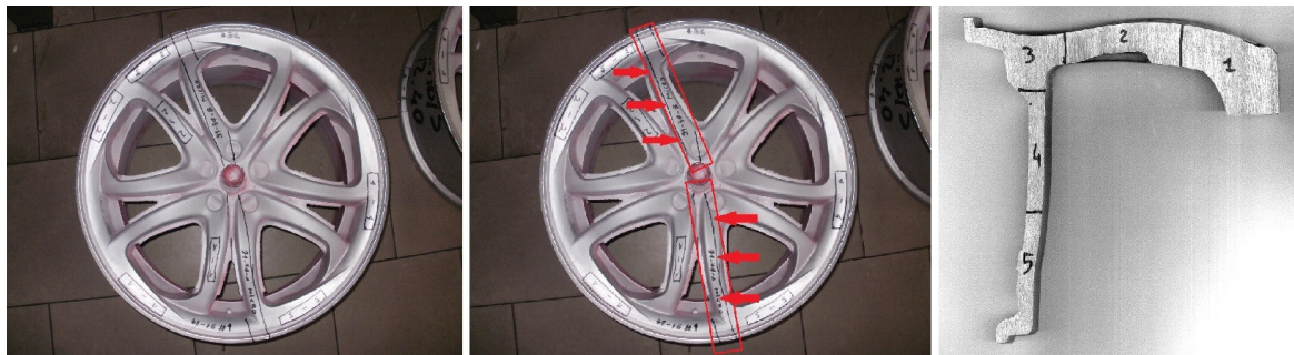
Figura 3.5 – Cerchio # 13-91-34; sezioni ricavate per le analisi e suddivisione di una sezione in 5 zone.
