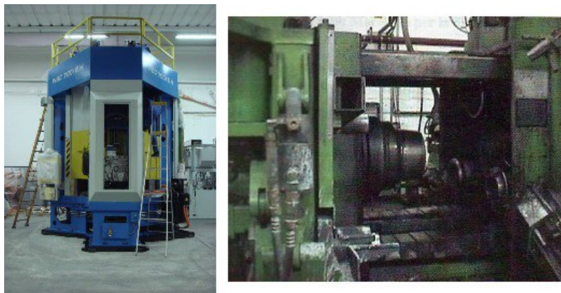
Figura 2.28 – A sinistra impianto di flow-formatura ad asse verticale; a destra, ad asse orizzontale.
