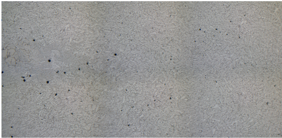
Figura 4.9 – Micrografia per la misurazione del contenuto di porosità e cavità sulla razza, cerchio # 13-150-1, sezione “B”. Livello d'ingrandimento 8x.
