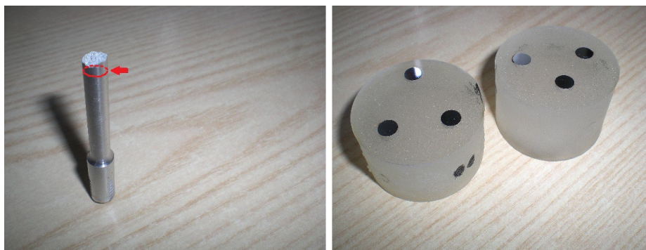
Figura 3.60 – A sinistra, spezzone di un provino dopo la prova di trazione. Nell'immagine è indicata la zona successivamente sezionata per la misurazione del DAS. A destra, gruppi di tre campioni inglobati nella resina.
