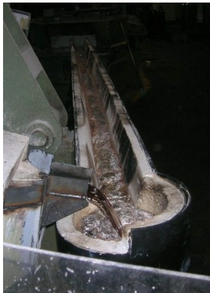
Figura 5.39 – Una possibile alternativa al trasporto della lega liquida in siviera: tramite canaline riscaldate, il metallo viene condotto nei forni delle macchine di bassa pressione. La ridotta velocità di deflusso impedisce fenomeni di “splash”, nonché l'introduzione nel bagno di lega di elevati quantitativi d'ossido. Si noti l'altezza di versamento in uscita limitata.
