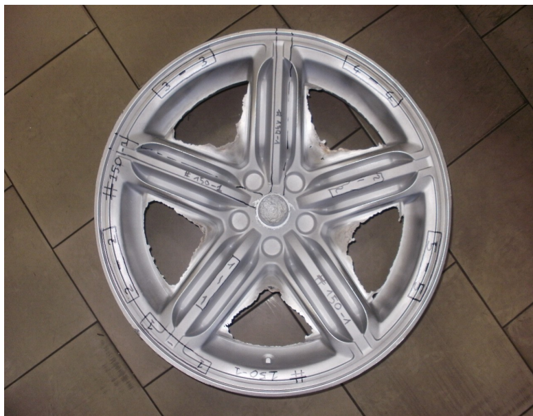
Figura 4.1 – Cerchio per flow-formatura Speedline SL 2159. Le sue dimensioni, come indicato nella designazione, sono maggiori rispetto a quelle del cerchio monoblocco: larghezza del canale pari a 9 pollici, diametro nominale del calettamento cerchio-pneumatico 19 pollici. Ogni razza principale è affiancata da due razze laterali più sottili.
