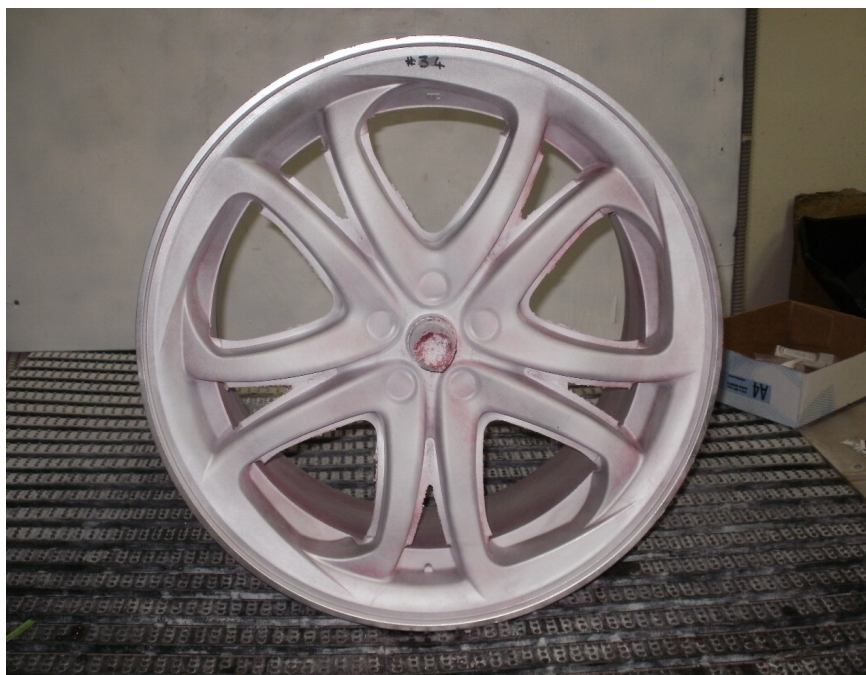
Figura 3.2 – Cerchio monoblocco Speedline SL 3313. La designazione riportata ad inizio paragrafo fornisce informazioni relative all'accoppiamento tra pneumatico e ruota: larghezza canale 8 pollici, tipologia di canale J, diametro nominale del calettamento cerchio/pneumatico 18 pollici, tipologia di calettamento interno ed esterno H2 (hump tradizionale).
