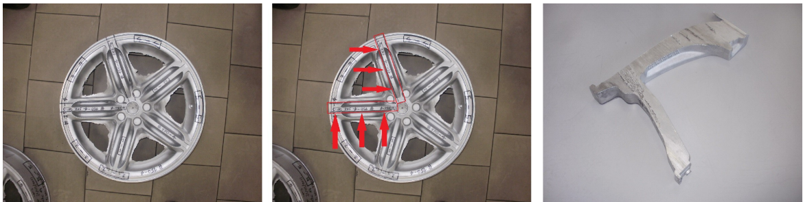
Figura 4.2 – Cerchio # 13-150-4 tracciato per ricavare le sezioni e i provini di trazione. Nell'immagine al centro le frecce indicano le superfici lucidate per le analisi. A destra, sezione completa.
