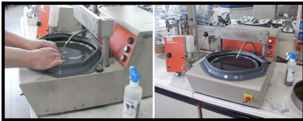
Figura 3.7 – Pulitrice a piatto rotante Struers Planopul-3 con Pedemax-2.
