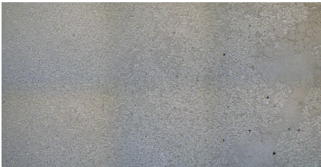
Figura 3.14 – Micrografia ottica dell'area impiegata per la misurazione della porosità percentuale in zona razza; cerchio # 13-91-34, sezione “B”. Si noti sulla parte destra dell'immagine una larga zona di segregazione eutettica dovuta al raffreddamento direzionale del getto, con la solidificazione della razza che segue quella del canale. Livello d'ingrandimento 8x.
