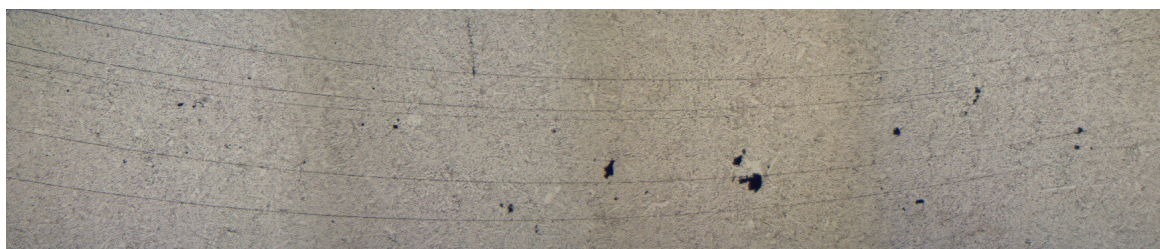
Figura 3.15 – Micrografia ottica per il calcolo del contenuto di porosità e cavità in zona canale; cerchio # 13-91-35, sezione “A”. Si noti la forma “allungata” delle cavità dovute a mancata alimentazione nella zona centrale dell'immagine, le quali seguono l'andamento delle dendriti. Livello d'ingrandimento 8x.
