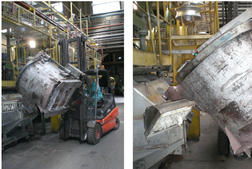
Figura 2.15 – Operazione di versamento della lega d'alluminio dalla siviera al forno di mantenimento della macchina di bassa pressione.
