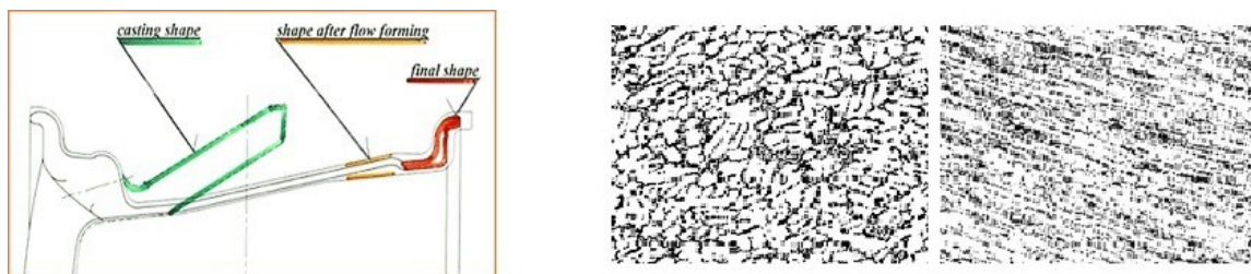
Figura 2.29 – A sinistra, sezione di un canale prima (in verde) e dopo (in giallo) la lavorazione di flow-forming. A destra, grano cristallino del getto, più grossolano, confrontato con il grano cristallino dopo flow-formatura, più fine e orientato.
