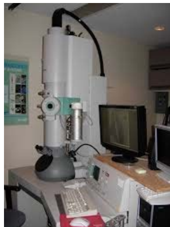
Figura 4.7: Schema e immagine di un TEM: nella figura a destra, di fianco alla camera per il vuoto, viene inserito un serbatoio riempito di azoto liquido per raffreddare lo strumento
