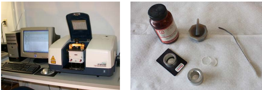
Figura 4.10: Uno spettroscopio a raggi infrarossi e la strumentazione utilizzata per la preparazione del supporto in KBr.
