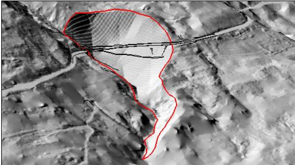
Figura 5.3.5. Visuale 3D dell'area di frana dopo la creazione della superficie di scivolamento.
