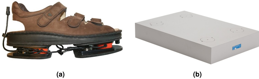
Figura 1.3: (a) La scarpa Force Shoe, sviluppata da xSens ha livelli di accuratezza di misura molto elevati. Risulta però ingombrante e costosa. (b) Pedana di forza Kistler in grado di misurare le forze (nelle tre direzioni spaziali) esercitate su di essa.
