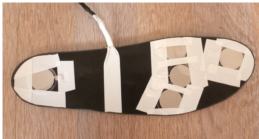
Figura 4.3: Ultima versione della soletta, sono ben visibili i cinque sensori Flexiforce A401.
