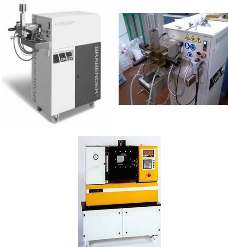
Fig.3.19 Plastografo Barebender (prime due immagini) e pressa a compressione P200P
