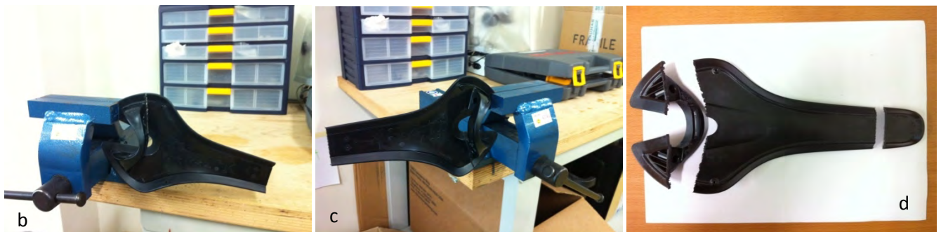
Figura 4 - prima sequenza di operazioni per ricavare i provini dal feltro (a, b, c, d)
