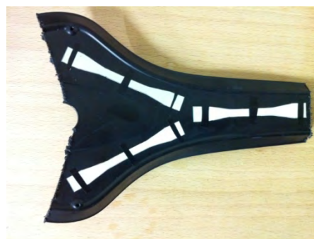
Figura 5 - Applicazione sagome di provini mediante nastro adesivo
