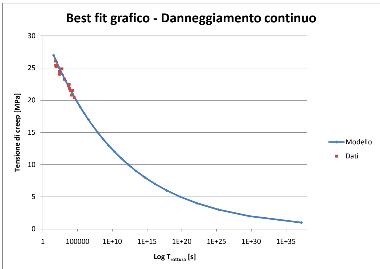
Figura 16 - Grafico del best fit preliminare implementato con Excel del criterio di danneggiamento continuo
