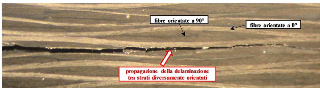
Figura 4.1: propagazione della delaminazione in una giunzione stepped-lap in materiale composito ([11] Lunardon, 2004-2005)
