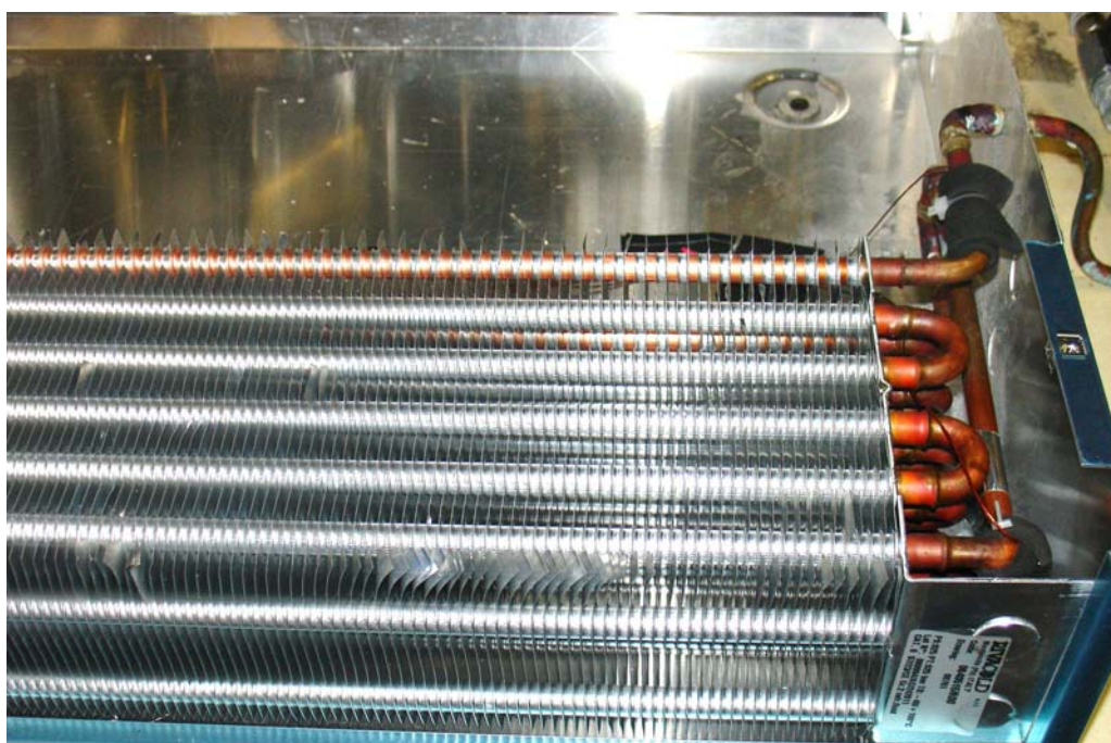
Figura 23 Termocoppie isolate all'ingresso ed uscita della batteria alettata
