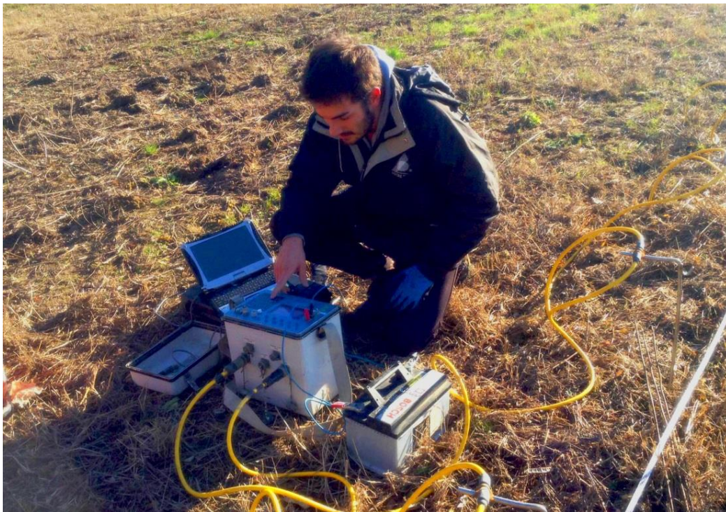
Figura 13: Utilizzo del georesistivimetro durante il lavoro sul campo
