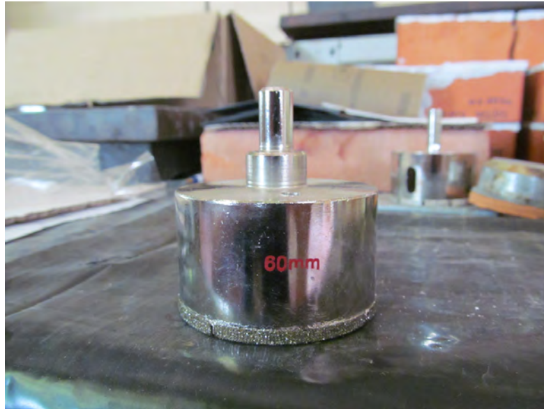
Figura 1.21: Tazza diamantata da 60 mm di diametro, prova pull-off
