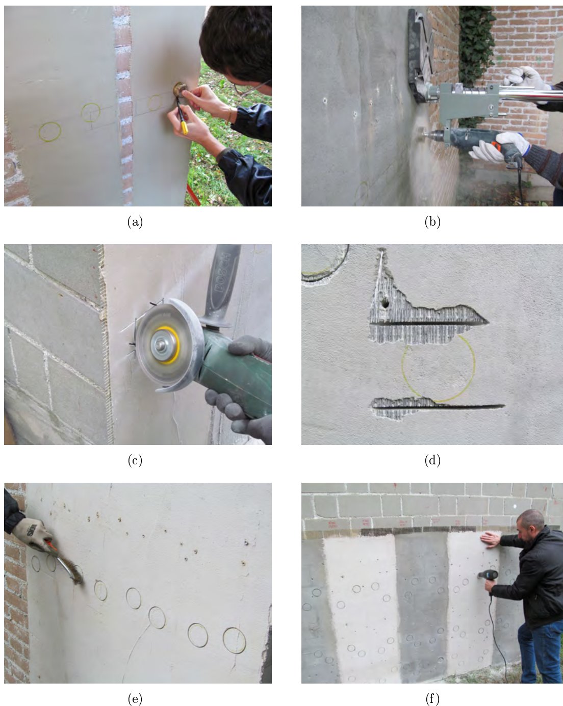
Figura 3.14: Procedura di preparazione dei provini per pull-off: disegno circonferenze (a), esecuzione taglio con tazza diamantata su trapano “a colonna” (b), esecuzione taglio con flessibile (c), dettaglio del distacco matrice superficiale nei compositi G2000_Geolite (d), spazzolatura pannello (e), asciugatura pannello (f)
