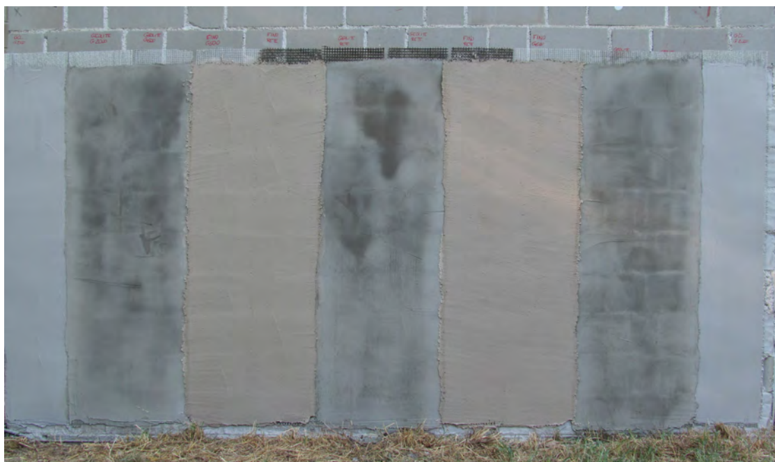
Figura 3.12: Pannello A5L (muratura in pietra) alla fine dell'applicazione dei compositi
