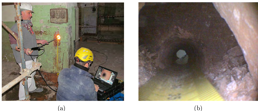
Figura 1.15: Sistema di prova per endoscopie (a), ove è visibile il dispositivo luminoso e il sistema di acquisizione dati; immagine endoscopica (b)
