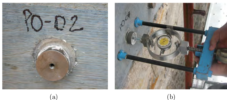
Figura 2.3: Pull-off test: (a) tasselli circolari; (b) esecuzione della prova (Borri et. al , 2009a)
