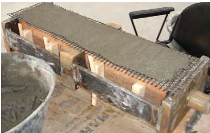
Figura 2.30: Prove di trazione CFRCM su muratura (Faella et. al. , 2009)
