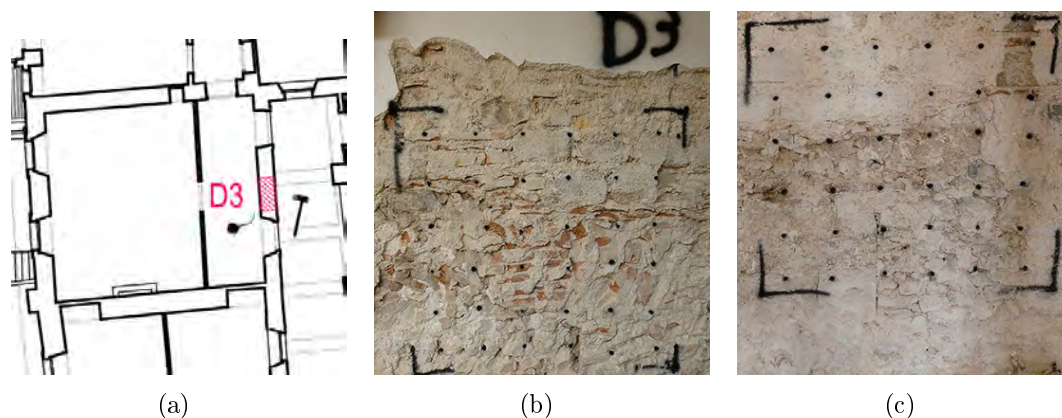
Figura 4.79: Schema prova sonica pannello D3 (a), lato martello (b) e lato accelerometro (c)
