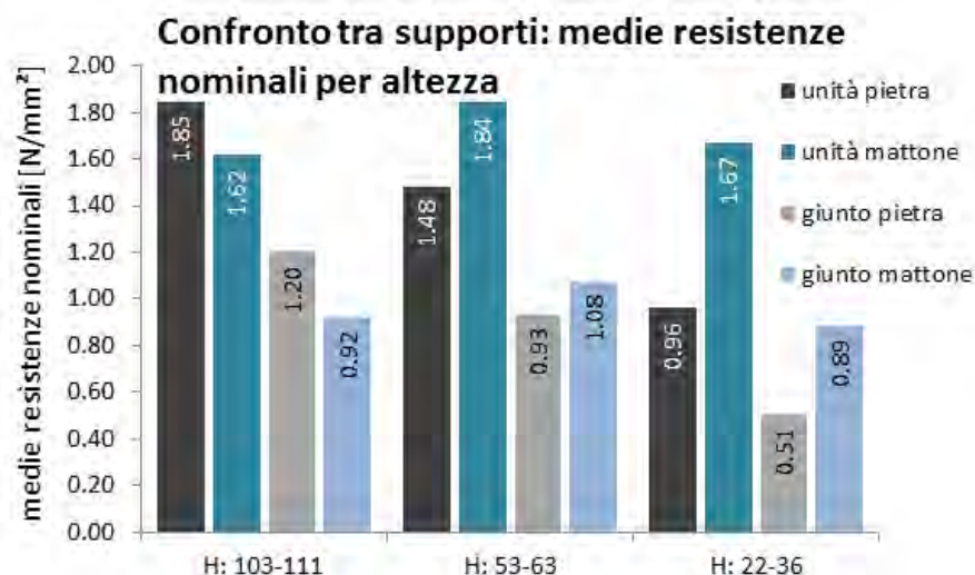
Figura 5.11: Confronto tra le resistenze nominali medie per i due diversi supporti (Gallo N., 2013)
