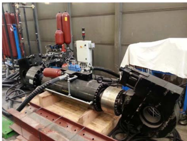
Figura 9.11: Attuatore oleodinamico da 1500 kN
