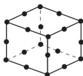
Figura 7.14: Elemento solido a 20 nodi, che utilizza un'interpolazione quadratica
