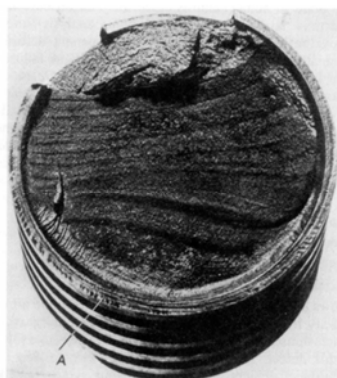
Figura 3.7: Sezione di un elemento rotto a fatica; si notano la zona liscia di accrescimento delle cricche, che occupa la maggior parte della sezione, e la zona ruvida della rottura di schianto nella parte superiore
