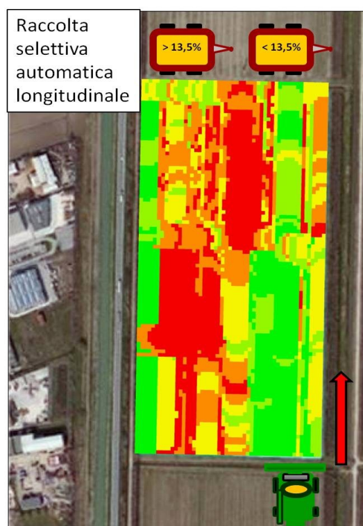
Figura 15: Raccolta selettiva automatica con cassone separato longitudinale
