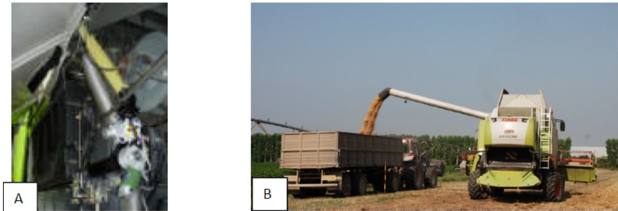
Figura 10: Spettrometro NIR installato sulla mietitrebbia (Grainit) (A) e scarico nei rimorchi (B)
