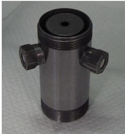
Figura 2.7: camera di scarica con anodo montato al suo interno attraverso il sistema di supporto.
