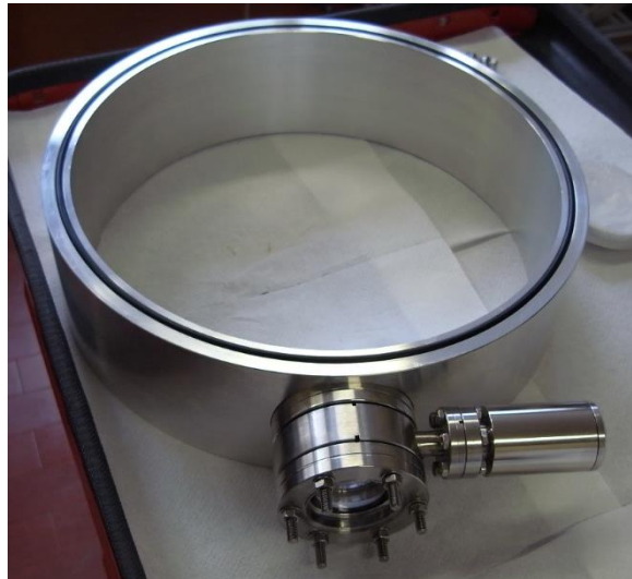
Figura 4.9: distanziale con finestra di osservazione e otturatore. Sul bordo dell'oggetto si nota che è stata inserita la guarnizione per la tenuta del vuoto nella cava realizzata appositamente.
