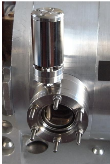
Figura 4.13: dettaglio della finestra di osservazione in Kodial® montata dopo l'otturatore per garantire la pulizia del vetro anche durante le prove con gli oggetti ad alta temperatura.
