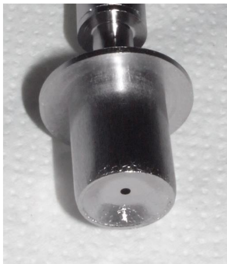
Figura 5.12: catodo con faccia frontale spanciata all'indietro dopo le prove di efficienza.
