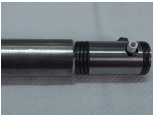
Figura B.5: Camera di scarica a cui sta venendo montato l'anodo, sostenuta dall'utensile appositamente costruito. Sotto l'isolatore di allumina bianco è presente il puntalino di supporto, e sopra andrà posto il dado di chiusura. Regolando la chiusura dei tre dadi presenti alla fine, si otterrà un corretto allineamento dell'anodo.
