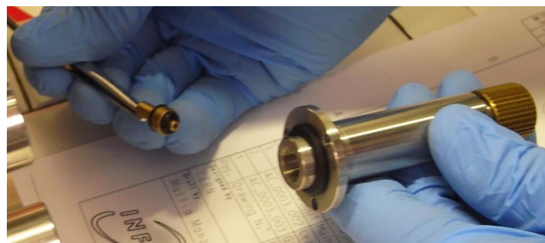
Figura B.15: Inserimento del nuovo leak nel suo alloggiamento.
