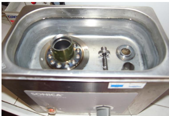
Figura B.2: Lavaggio dei componenti nella lavatrice ad ultrasuoni presente presso i laboratori nazionali di Legnaro
