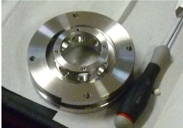
Figura B.16: componenti del sistema di bloccaggio in acciaio durante la fase di montaggio.
