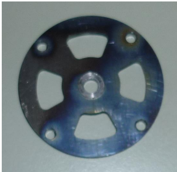
Figura B.17: disco in Tantalio con alleggerimenti e foro lamato centrale per consentire l'accoppiamento con la linea di trasporto della corrente già esistente.
