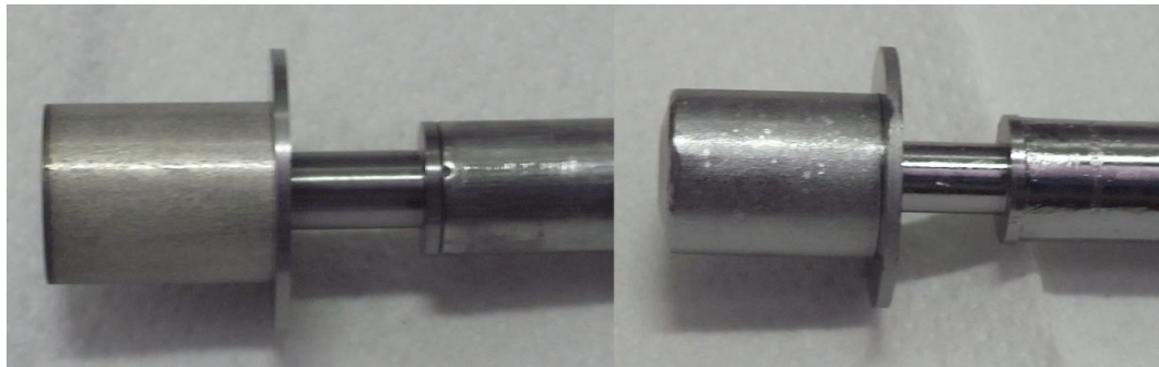
Figura 4.26: catodo saldato TIG prima (a sinistra) e dopo (a destra) il montaggio. Si nota come la faccia frontale si sia deformata in avanti.
