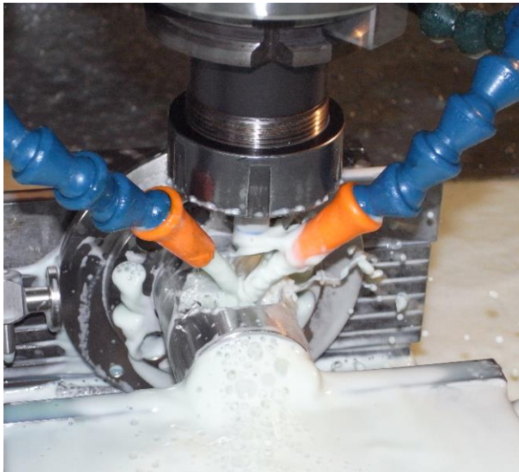
Figura 4.4: foratura dei componenti con fresatrice a controllo numerico.
