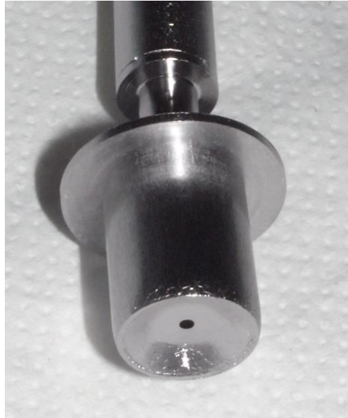
Figura 4.7: catodo dopo essersi deformato in verso contrario di quello atteso.
