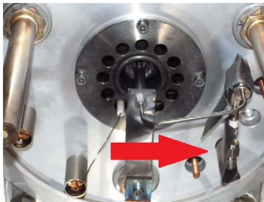
Figura B.13: Sorgente con linea di trasferimento del gas collegata al piatto della camera da vuoto. La freccia rossa indica la zona in cui si trova la cava del piatto entro cui viene posizionato il leak.
