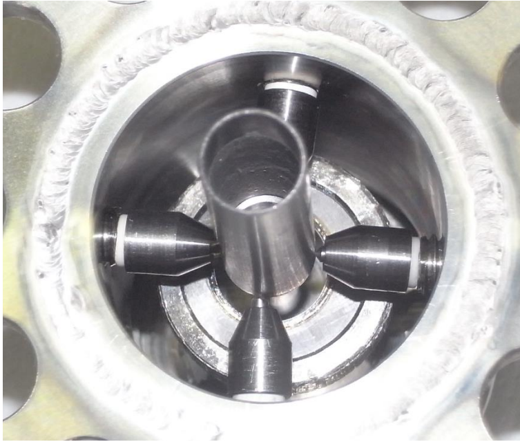
Figura 6.14: fotografia della sorgente con sistema di centraggio, montato per l'esecuzione delle prove di efficienza. Si può osservare anche il cordone di saldatura fra camera e flangia di supporto descritto nel paragrafo successivo.
