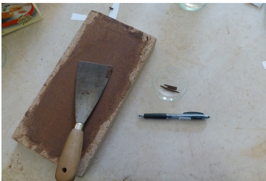
Fig. 19: Piccoli cilindri di terreno sul vetrino dopo la stesura dello stesso sulla pietra porosa (a sinistra)
