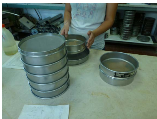
Fig.16: Analisi granulometrica previa batteria di setacci ASTM
