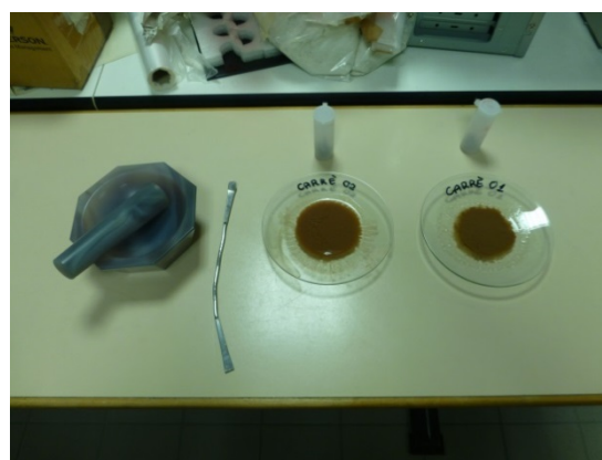
Fig.21: Mortaio con pestello d'agata e vetrini orologio.
