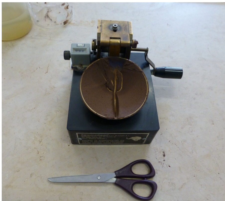
Fig.18: Cucchiaina di Casagrande utilizzata per il limite liquido
