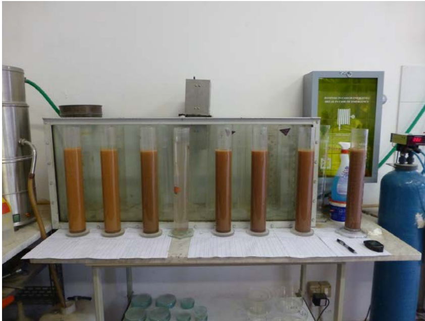
Fig.17: Cilindri graduati contenenti terreno, acqua distillata e antiflocculante. Nel cilindro con acqua distillata è presente il densimetro o aerometro
