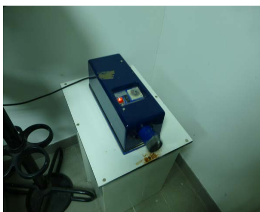
Fig.20: Macchina scuotitrice con giara inserita in funzione
