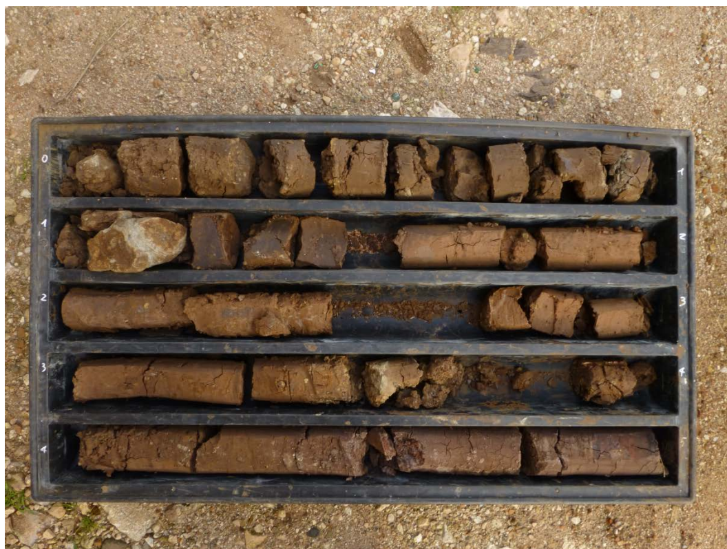
Fig.8: Carotaggio da 0 a 5 metri (dall'alto verso il basso). La mancanza di materiale nella prima cassetta catalogatrice è dovuto a prelievi da parte del geologo incaricato ai fini della redazione della relazione geologico-tecnica
