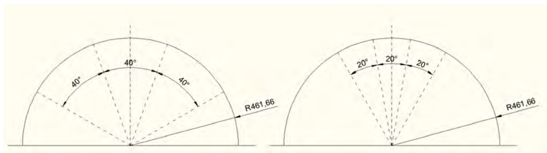
Figura 5.4: Quote per le due configurazioni di cella considerate. I valori riportati sono sufficienti per identificare le coordinate cartesiane nel riferimento xy del manipolatore.
