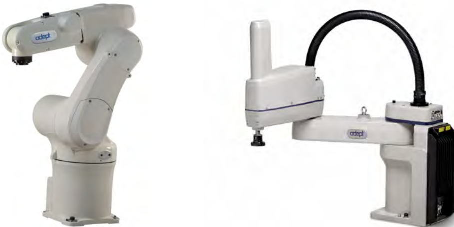
Figura 1.3: Esempi di manipolatori industriali. Robot a 6 assi Adept Viper s650 (sinistra) e robot a 4 assi Adept Cobra s800 di tipologia SCARA (destra).
