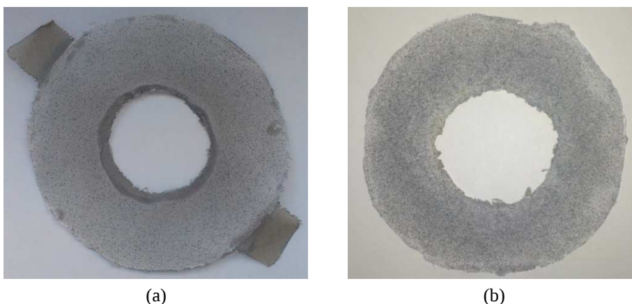
Figura 4.4 Membrana in PAN con 3 mg di grafene (a) e membrana in PAN con 3 mg di grafene e \text{TiO}_2 (b).
