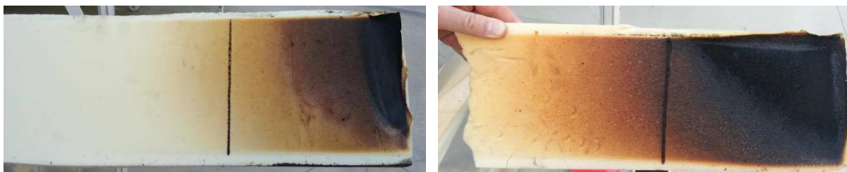
Figura 9.13 Campione R20IPA (sinistra) e B20IPA (destra) al termine del test del pannello radiante.
