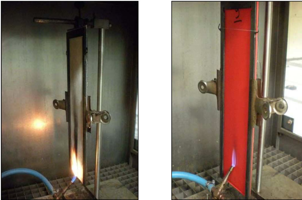
Figura 5.2 Prova applicazione di piccola fiamma (a) UNI 8456 e (b) UNI 8457.
