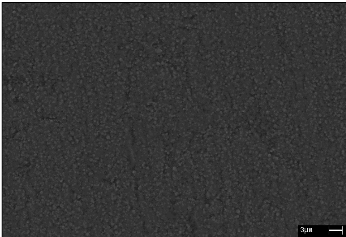
Figura 3.8 Immagine SEM del rivestimento di Nickel del contatto
