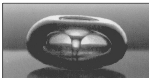
Figura 1.3 Collasso asimmetrico di una bolla a 25kHz [p].
