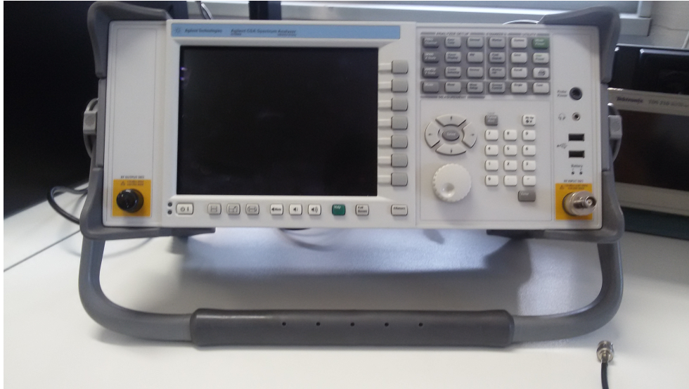
Figura 5.7: Analizzatore di spettro Agilent CSA Spectrum Analyzer N1996A utilizzato
