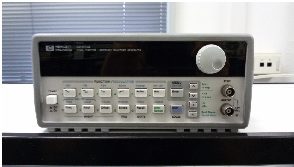
Figura 5.6: Generatore d'onda utilizzato: Hewlett Packard 33120A
