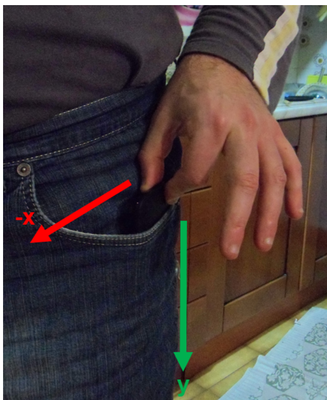
Figura 5.1: Posizione del telefono affinché l'applicazione operi in modo corretto. Gli assi indicati si riferiscono al sistema di riferimento Smartphone originale.
