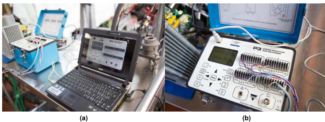
Figura 6.5: Centralina P3 Vishay Micro-Measurements per l'acquisizione dei segnali.
