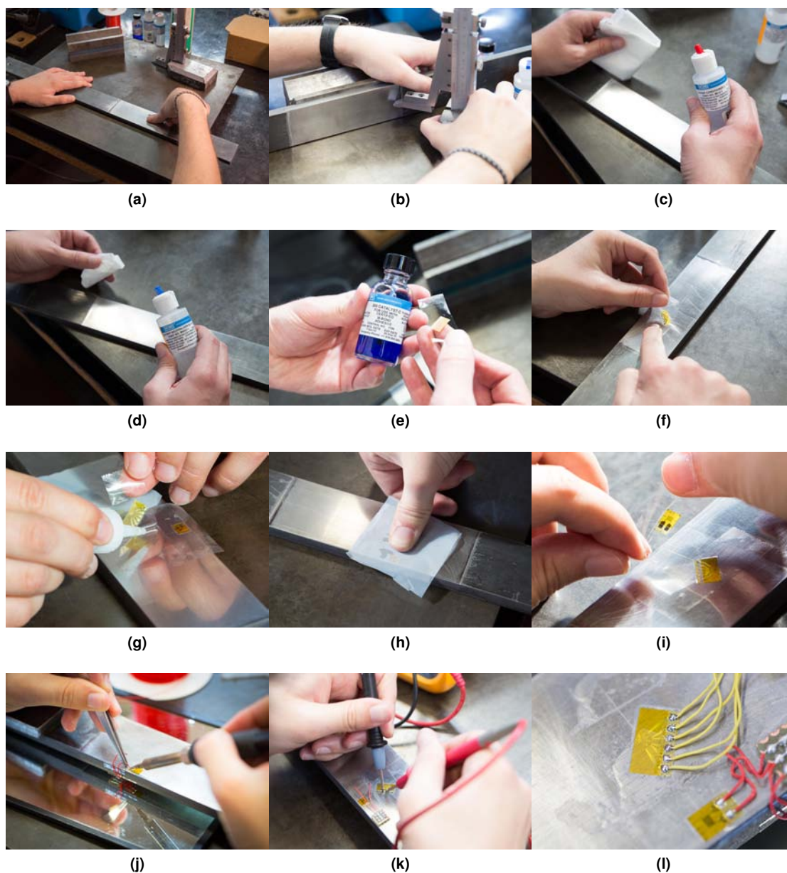
Figura 6.4: Passaggi effettuati per l'incollaggio degli estensimetri.
