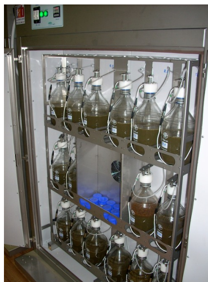
Figura 1.4: reattore pilota per il calcolo del BMP (Laboratorio CRPA)
