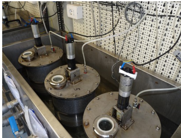
Figura 1.3: reattore pilota per il calcolo del BMP (laboratorio CRPA)
