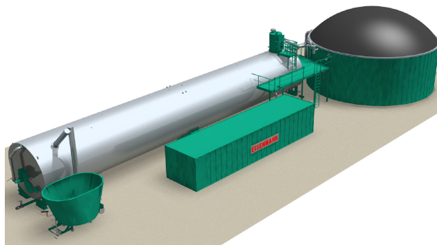
Figura 3.3: tipologia impiantistica con reattore cilindrico ( www.bregalantisrl.it )
