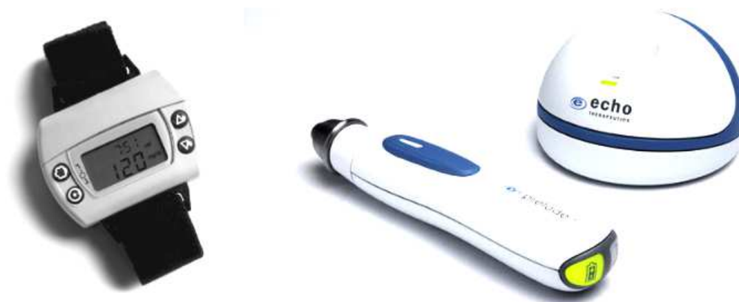
Figura 1.7. A sinistra, il GlucoWatch G2 Biographer (Cygnus Inc., Redwood City, CA). A destra, il SonoPrep (Echo Therapeutics Inc., Philadelphia, PA), utilizza la sonoforesi (immagini tratte da [16], [17]).
