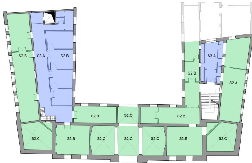
Fig. 8.2.2-02: Tipologia di orizzontamenti piano primo.
