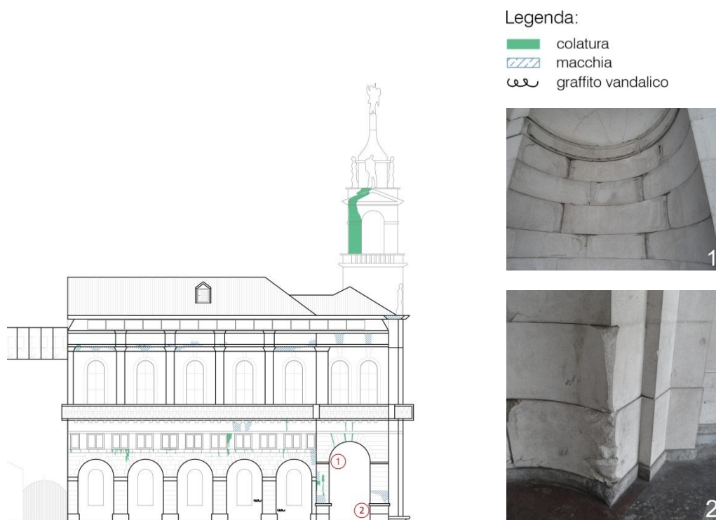
Fig. 6.4.2-03: Stato di degrado della facciata su via del Municipio.
