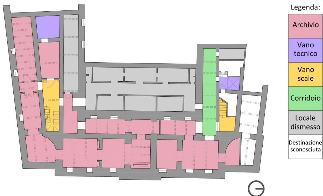
Fig. 4.4-01: Destinazioni d'uso piano interrato.
