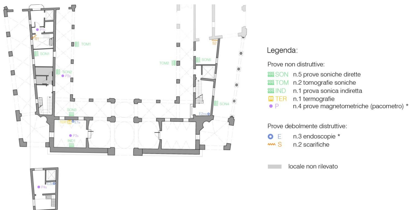
Fig. 5.1-02: Piano delle indagini, piano terra.
