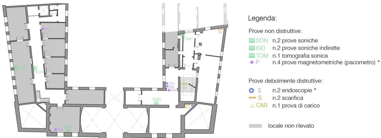
Fig. 5.1-03: Piano delle indagini, piano primo.
