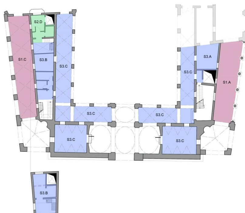
Fig. 8.2.2-01: Tipologia di orizzontamenti piano terra.
