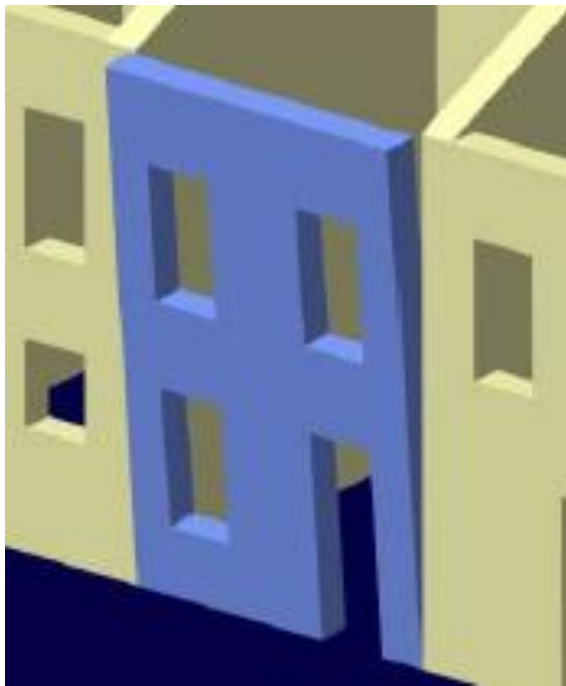
Fig. 8.3.1-01, 02: Ribaltamento semplice di parete monolitica e sua schematizzazione. Fonte: Schede illustrative dei principali meccanismi di collasso locali – ReLUIS.
