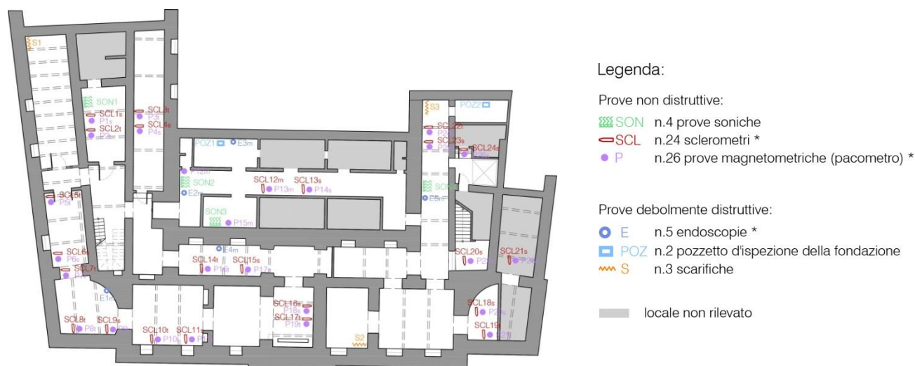
Fig. 5.1-01: Piano delle indagini, piano interrato.
