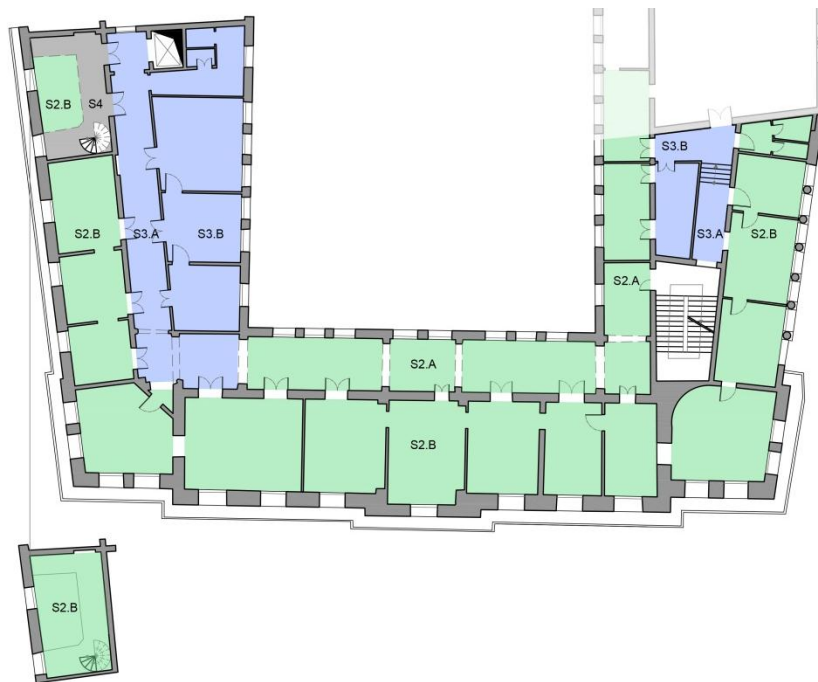
Fig. 8.2.2-03: Tipologia di orizzontamenti piano secondo.
