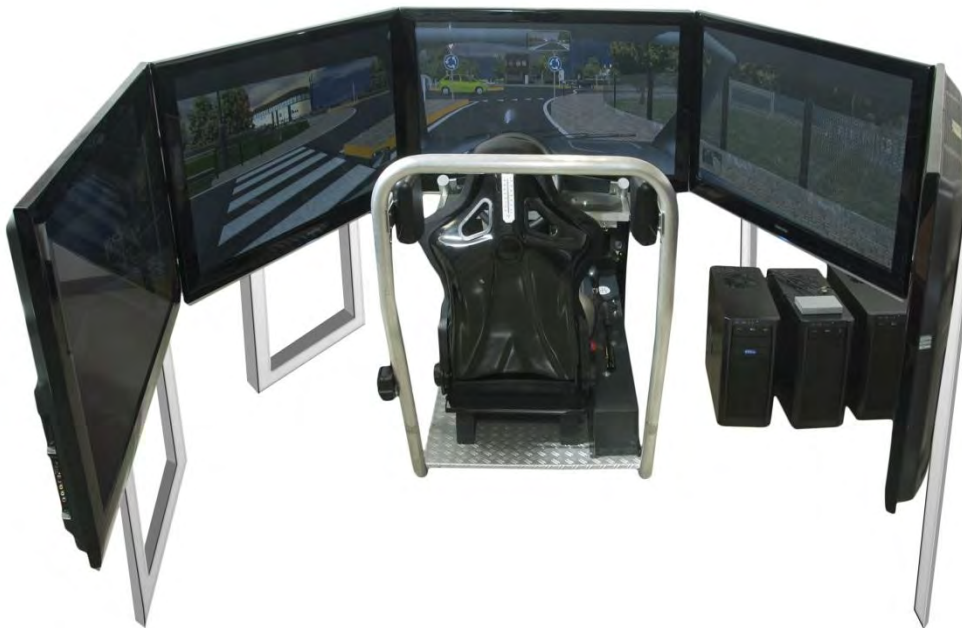
Figura 41 - Visione d'insieme del simulatore di guida: abitacolo, schermi, PC
