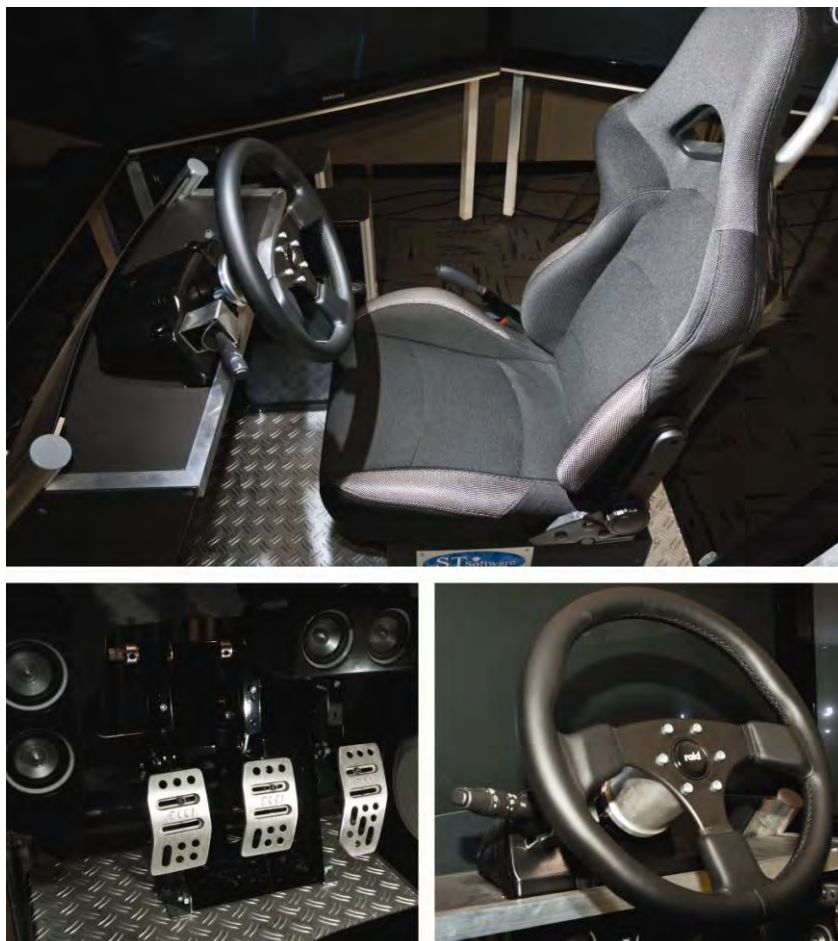
Figura 40 - Abitacolo, pedaliera, volanti e comandi del simulatore di guida
