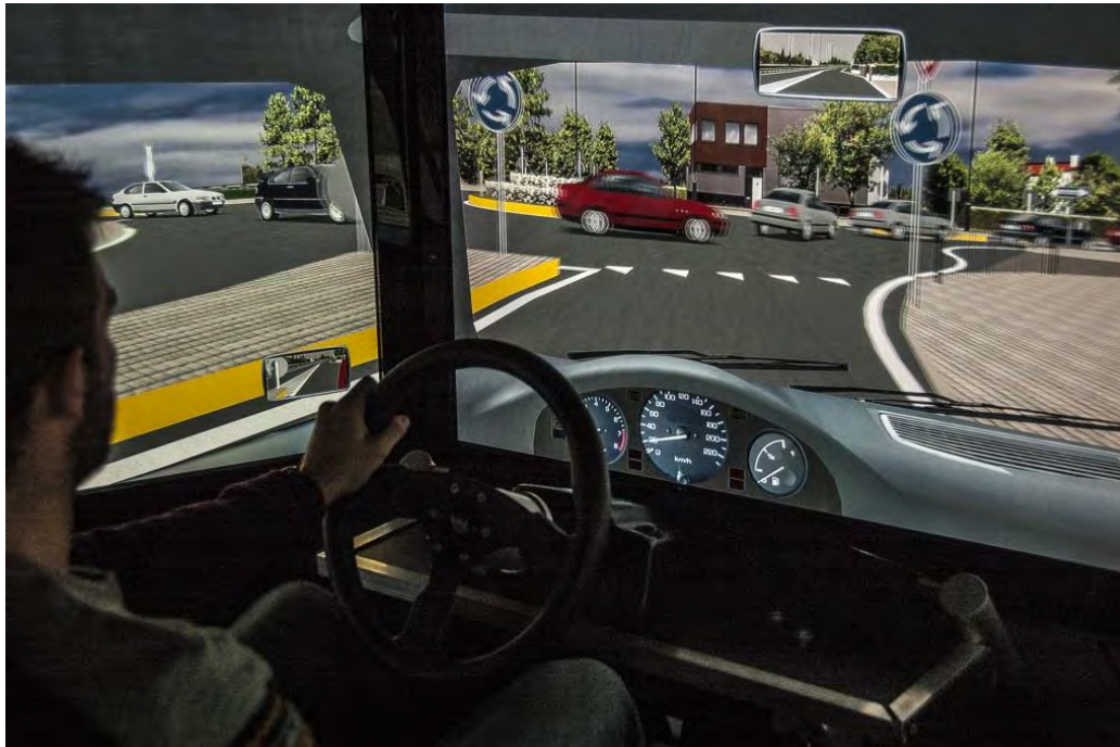
Figura 62 - Istantanea dell'esperimento al simulatore di guida. Fase di selezione del gap ottimale della corrente di traffico nell'anello circolatorio per eseguire la manovra di attraversamento in sicurezza
