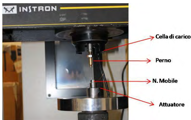
5.15: Cella di carico usata per caratterizzazione delle molle;
