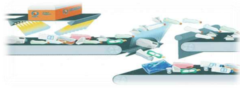
Fig. 5.3: Impianto di selezione ottico-pneumatica
