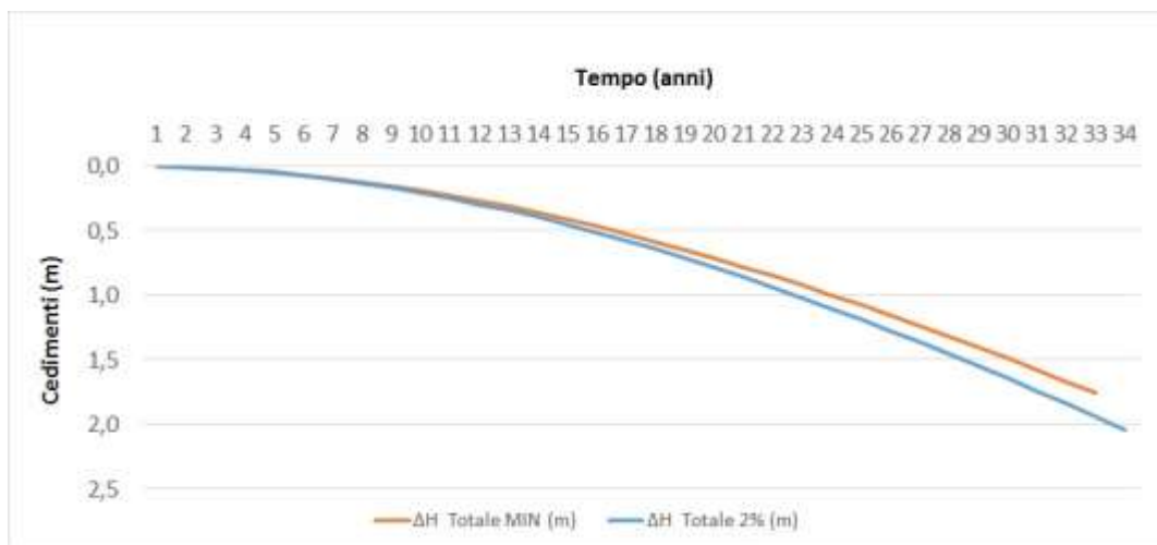
Figura 9.4.1.3: Risultati ottenuti con un variazione del 2% sui parametri di compressibilità
