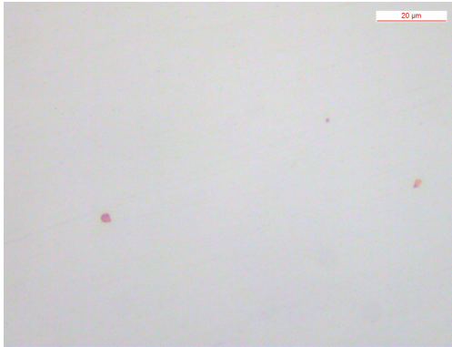
Figura 3.25: microstruttura della sezione di rottura a 710 mm dalla base a cuore della lama S 10-14; sezione nella quale si possono apprezzare 3 inclusioni di TiN (pre-attacco).
