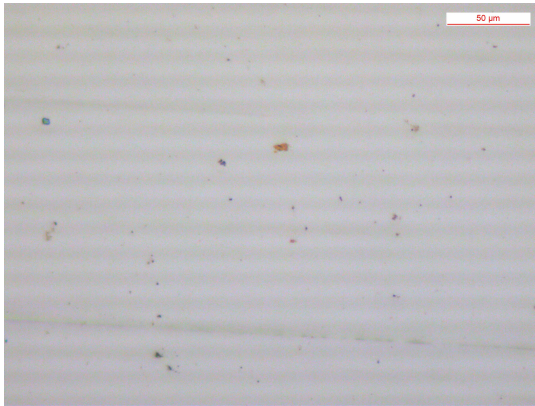
Figura 3.21: microstruttura della sezione di rottura a 730 mm dalla base a cuore della lama U 10-14; sezione nella quale si possono apprezzare inclusioni di TiC e TiN (pre-attacco).
