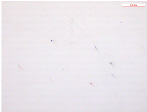
Figura 3.18: microstruttura della sezione di rottura a 450 mm dalla base a cuore della lama U 01-14; sezione nella quale si possono apprezzare inclusioni di TiC e TiN (pre-attacco).
