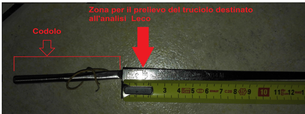
Figura 2.3: parte iniziale della lama, comprensiva del codolo.
