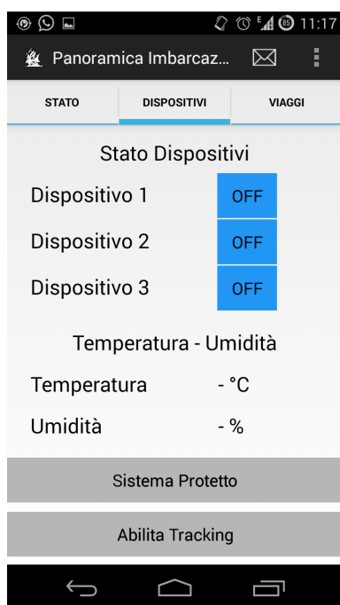
Figura 24: DispositiviActivity, assenza sensore di temperatura e umidità
