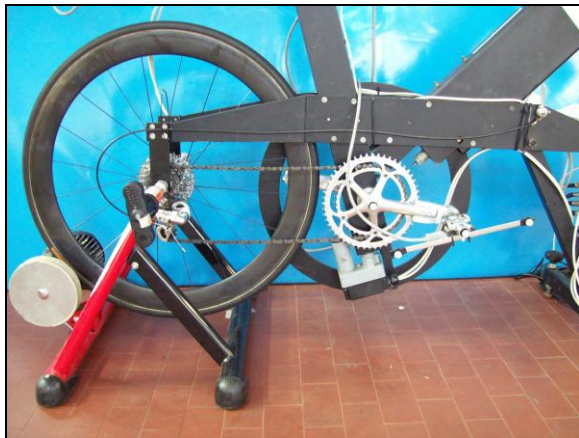
Figura 5.5 Posizionamento rulli e pedivelle
