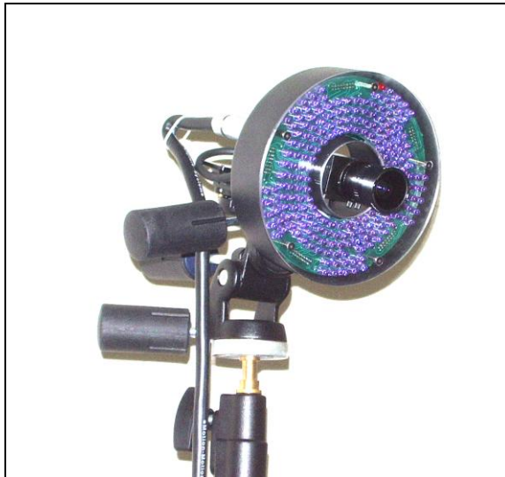
Fig 1.12: Telecamera a infrarossi con illuminatore.
