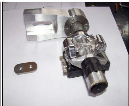
Figura 3.16: Attacco assemblato con il pedale
