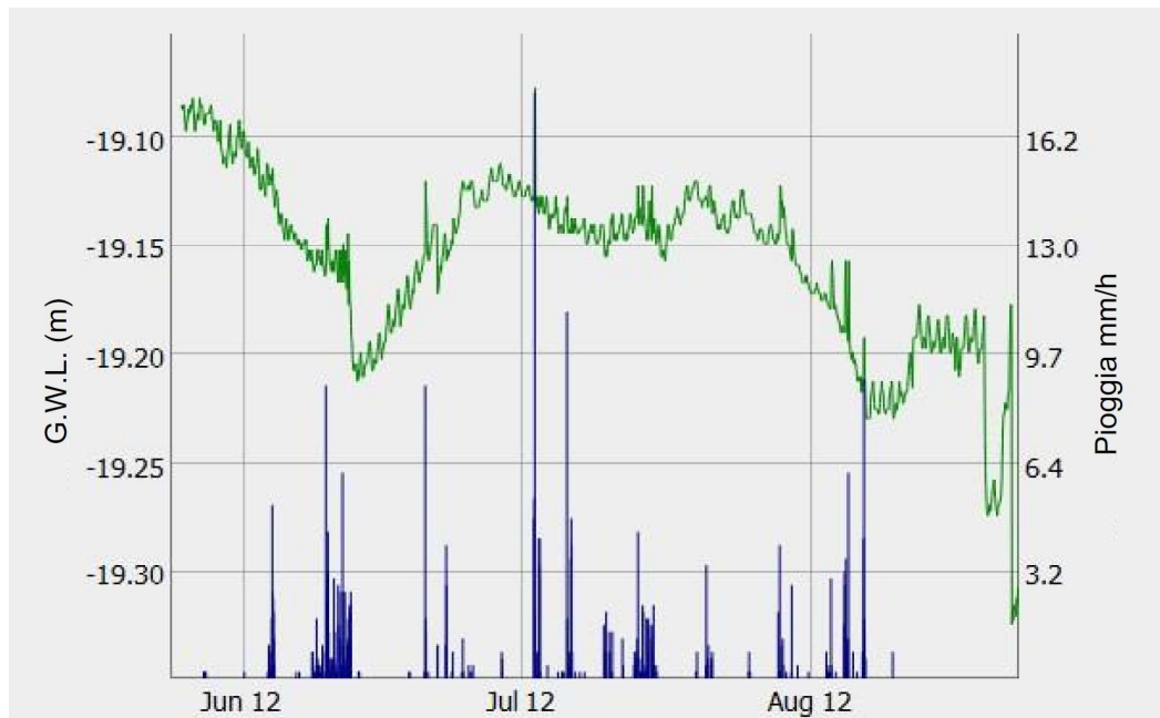
Figura 31 Andamento della quota piezometrica (traccia verde) nel sondaggio Monitor II/2 e della pioggia oraria (barre blu) nell'intervallo giugno-settembre 2012
