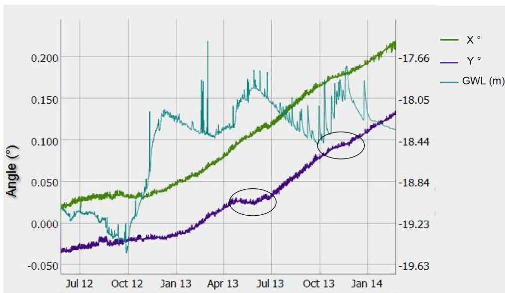
Figura 30 Andamento della variazione angolare dell'inclinometro GA02 nelle direzioni x ed y e della quota piezometrica all'interno del foro Monitor II/2 nel periodo maggio 2012-febbraio 2014
