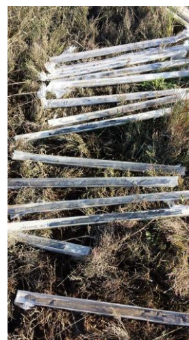
Figura 4.2: Insieme di carote prelevate e trasferite nei portacampioni.
