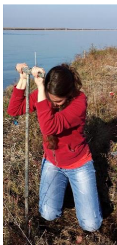
Figura 4.1: La foto mostra il carotiere in fase di infissione nel terreno.
