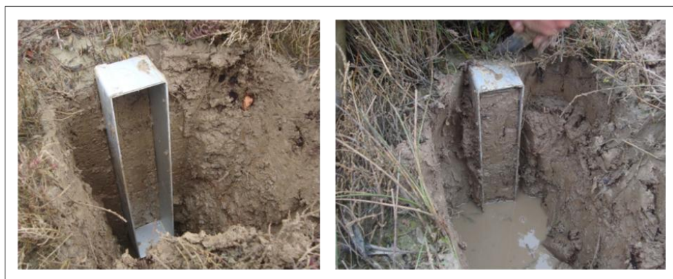
Figura 4.4: Le foto mostrano le “cornici” utilizzate per il campionamento.
