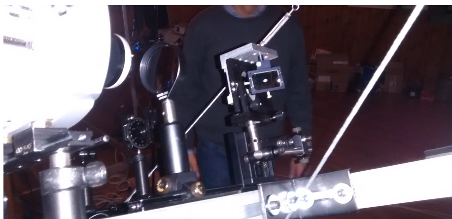
Figura 4.10: La luce riflessa dallo specchio forato viene focalizzata nella camera di campo
