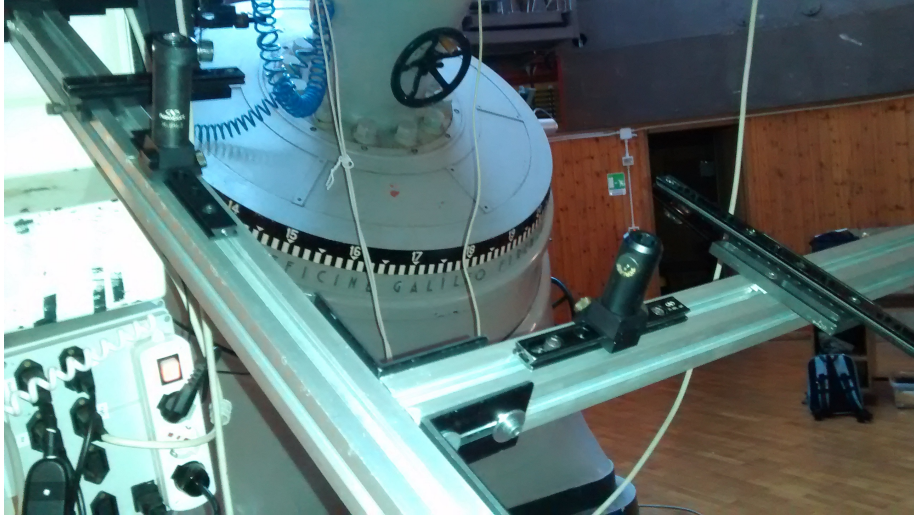
Figura 4.5: Profilati disposti a T aggangiati al foro del Galileo
