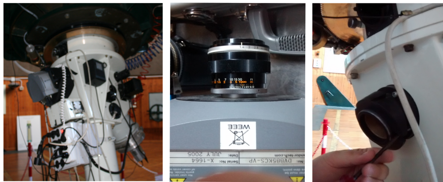
Figura 4.4: A sinistra la camera di campo montata sullo strumento del Galileo. In centro la camera di campo. A destra il foro in cui era fissata
