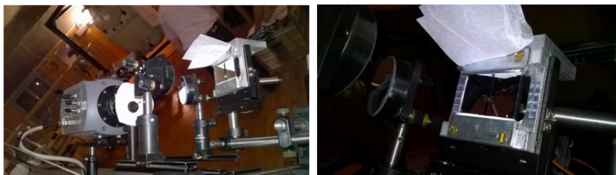
Figura 4.12: Coppia di specchi montata con inclinazione variabile
