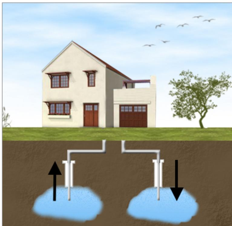
**Figura 56.** Schema di un tipico impianto a circuito aperto ad acqua di falda (geothermalinstallation.wordpress.com).
