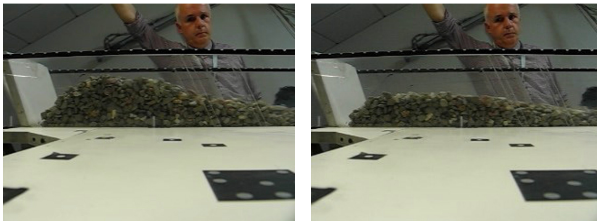
Figura 7.19: Le immagini sono state estratte dal video trasversale con ottica parallela al piano di monte, considerando la forma iniziale dell'ammasso si nota come i primi clasti ha mettersi in moto siano quelli adiacenti alla paratoia mobile e posti in superficie. Questo accade perchè in quella zona, alla rimozione della paratoia, si ha il massimo gradiente sulla superficie libera. Dopo, circa 1s , la situazione è quella nell'immagine a destra, il profilo dell'ammasso tende a disporsi parallelamente all'inclinazione del pendio mentre sul fondo le particelle rimangono sostanzialmente immobili.
