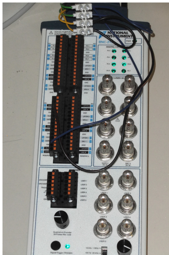
Figura 3.10: La scheda National Instrument utilizzata per la gestione della contemporanea attivazione delle videocamere.
