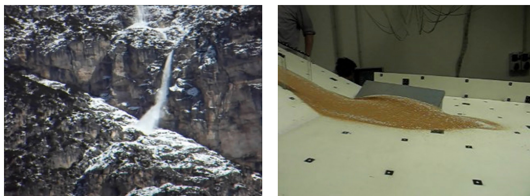
Figura 7.35: A sinistra, valanga di neve granulare ripresa nel versante meridionale del gruppo del Sorapiss. A destra l'ammasso zeolitico che collide con il deviatore. La natura granulare dei fenomeni permette di accomunarli da un punto di vista reologico.
