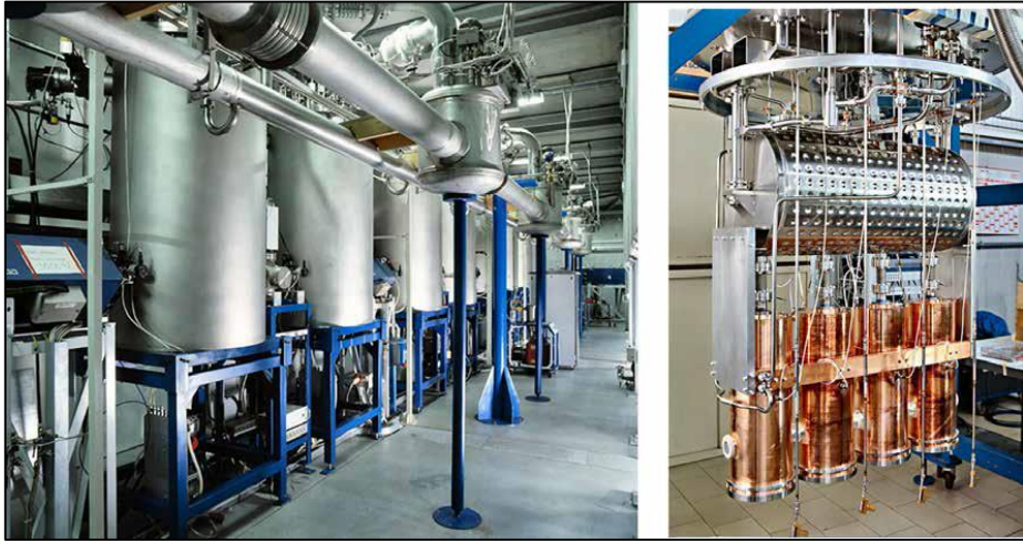
Fig. 1.15 A sinistra, un tratto del linac ALPI. In evidenza i criostati, recipienti che contengono ed isolano termicamente le cavità superconduttive (a T=-269 °C). A destra, l'interno di un criostato, con 4 cavità acceleranti su base di rame.
