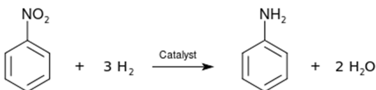
Figura 3.1 :Reazione stechiometrica di idrogenazione del nitrobenzene.
