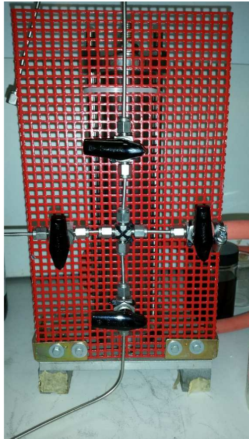
Figura 5.3 : Sistema a croce a 4 valvole usato nella nuova configurazione dell'apparato sperimentale.
