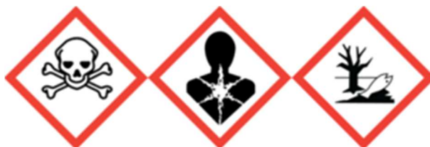
Figura 3.6 :Pittogrammi di pericolo validi per il nitrobenzene. Da sinistra a destra : Tossicità acuta, Tossicità a lungo termine, Nocivo per l'ambiente e gli organismi.
