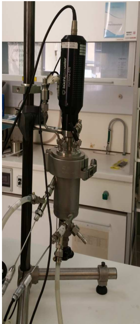
Figura 4.1 : Calorimetro di laboratorio munito del motore della rotante di agitazione interna.
