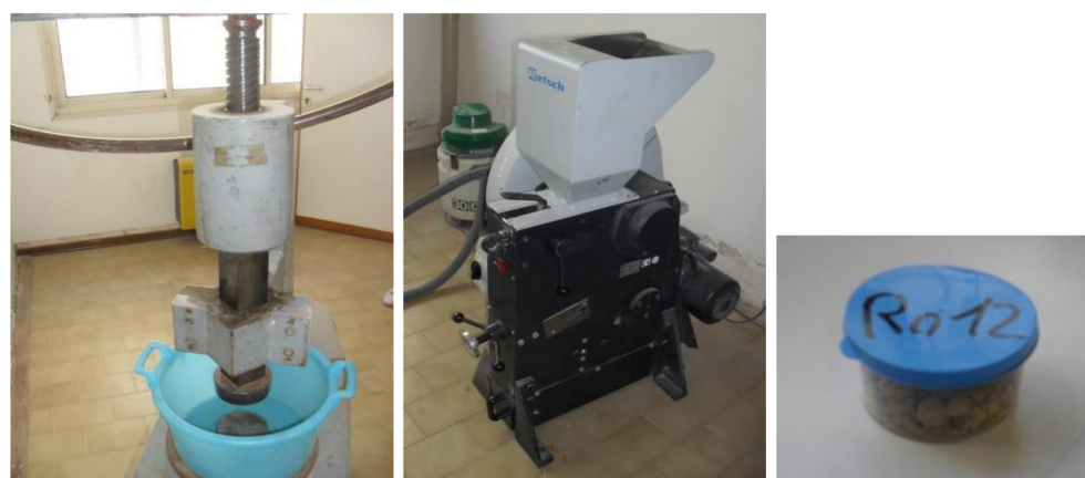
Fig. 15. Foto dei frantoi e del risultante campione destinato all'esame spettrometrico.
