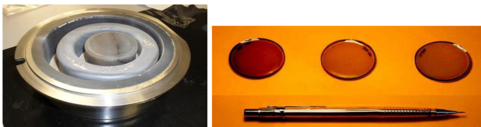
Fig. 16 Foto mulino a dischi in agata e le perle risultanti.
