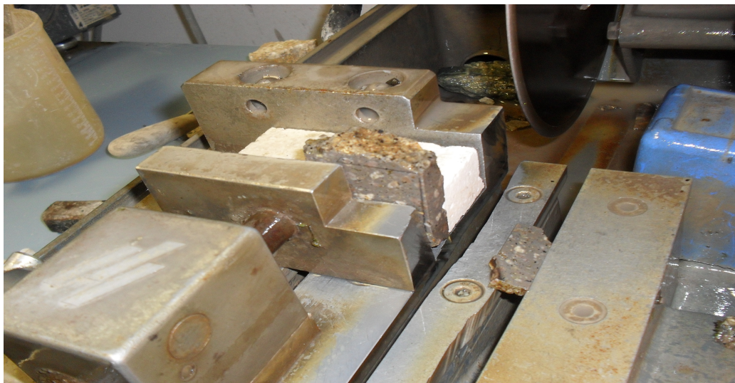
Fig. 14. Foto troncatrice durante il taglio di un campione.
