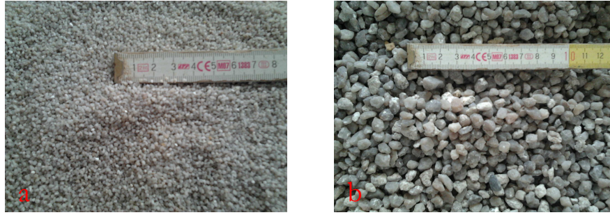
Figura 7: Sabbia di quarzo normalizzata, utilizzata per il confezionamento delle malte: a) granulometria 1-2 mm; b) granulometria 5-8 mm.
