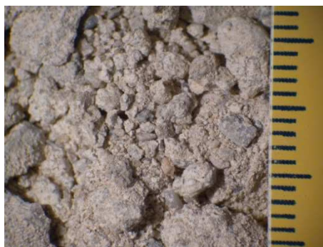
Fig. 4.1.2: Immagine allo stereomicroscopio, malte di colore grigio giallastro, aspetto dimensionale conglomeratico fine, campione TOR-4.
