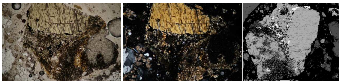
Fig. 1.7: Immagine al microscopio ottico di un aggregato di scisto cloritico, campione TOR-12. OM-TL: a) nicol paralleli, b) nicol incrociati. La base dell'immagine corrisponde a 3,4 mm. (ingrandimento 100X). c) foto BSE al SEM.
