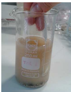
Fig. 5.1.2: Disgregazione del campione con il pestello di vetro.
