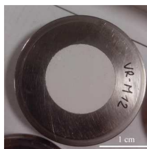
Fig. 3.8.2: Campione caricato su un portacampioni piatto per l'analisi XRPD.
