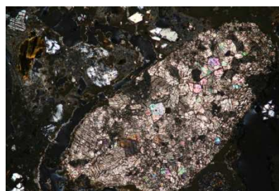
Fig. 4.2.8: Immagine al microscopio ottico di un aggregato carbonatico a nicol incrociati, campione TOR-1. La base dell'immagine corrisponde a 3,4 mm. (ingrandimento 50X).
