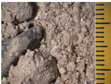
Fig. 4.1.3: Immagine allo stereomicroscopio, malte di colore grigio aranciato rosato, aspetto dimensionale conglomeratico grossolano, campione TOR-5.
