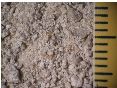
Fig. 4.1.1: Immagine allo stereomicroscopio, malte di colore grigio aranciato, aspetto dimensionale conglomeratico grossolano, campione TOR-3.
