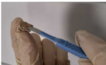
Fig. 5.1.1: Fase di pulitura del legante.
