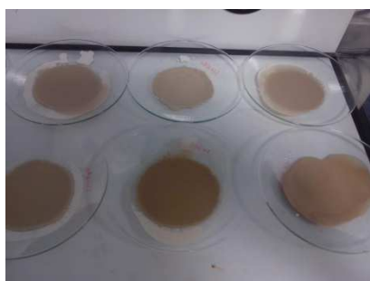
Fig. 3.8.1: Campioni micronizzati posti sotto cappa per la fase di essiccamento.
