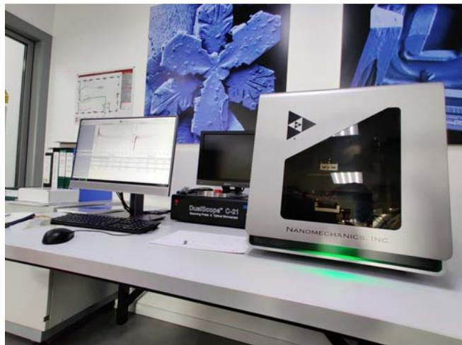
Figura 5.8.1: Macchinario impiegato per i test di Nanodurezza.
