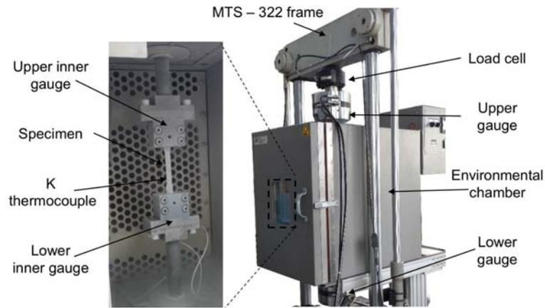
Figura 5.2.1: Macchina servo idraulica accessoriata di camera climatica
