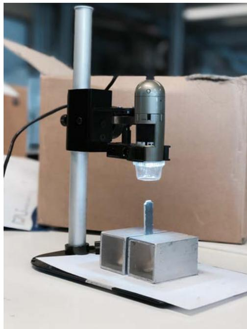
Figura 5.3.1: Microscopio digitale DinoCapture e provino fratturato bloccato mediante due blocchi in metallo.
