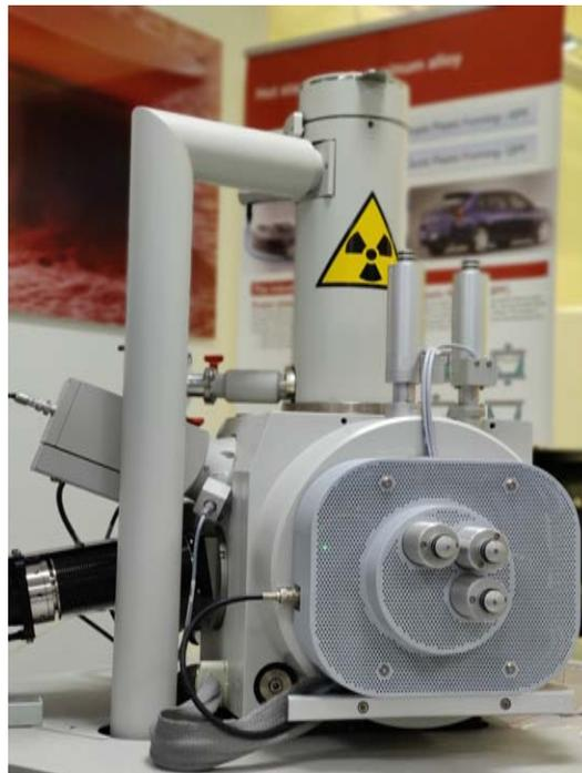
Figura 5.5.1: Microscopio a scansione elettronica.
