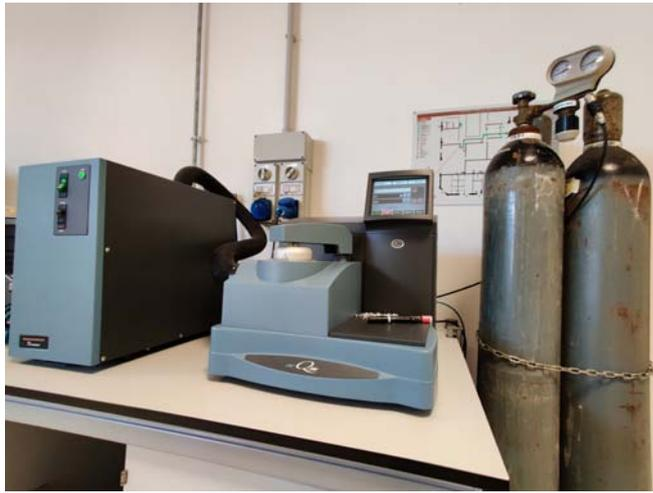
Figura 5.7.1: Calorimetro a scansione differenziale modello Q200, prodotto da TA instruments.
