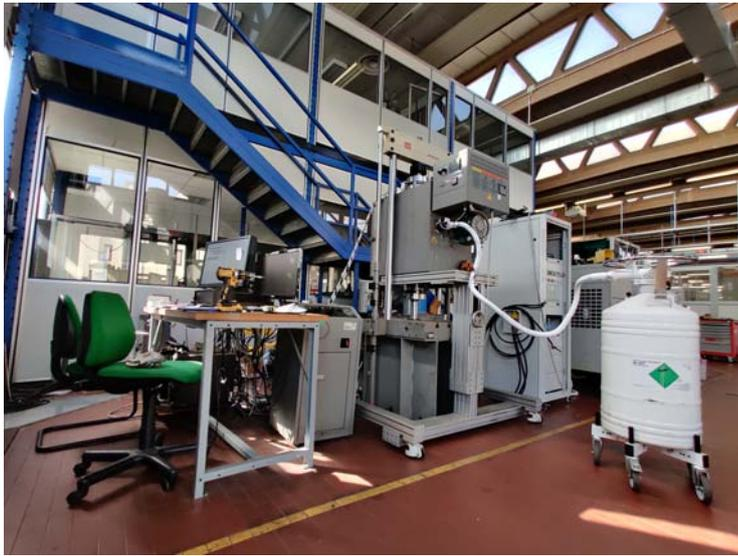
Figura 5.2.3: Presso servo-idraulica accessoriata di camera climatica e bombola di azoto liquido.
