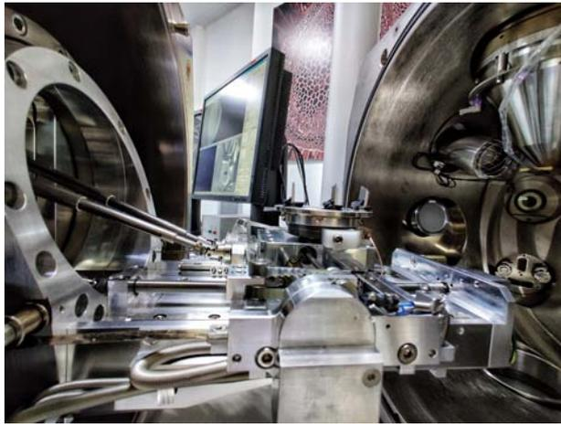
Figura 5.5.2: Posizionamento dei campioni all'interno del carrello del SEM.
