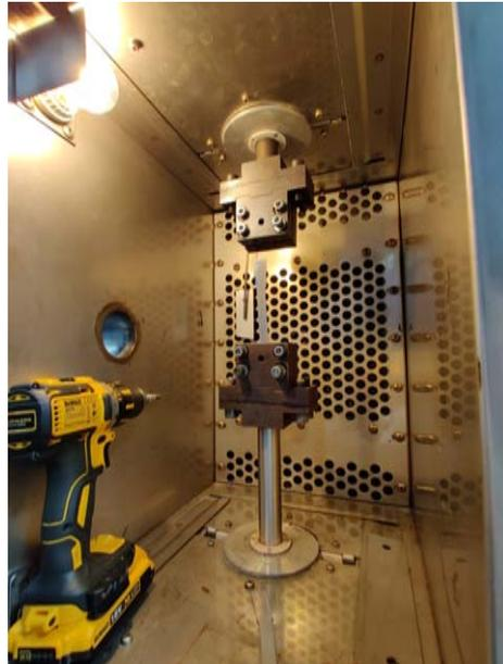
Figura 5.2.2: Interno della camera climatica. Un provino è stato agganciato alla morsa inferiore.
