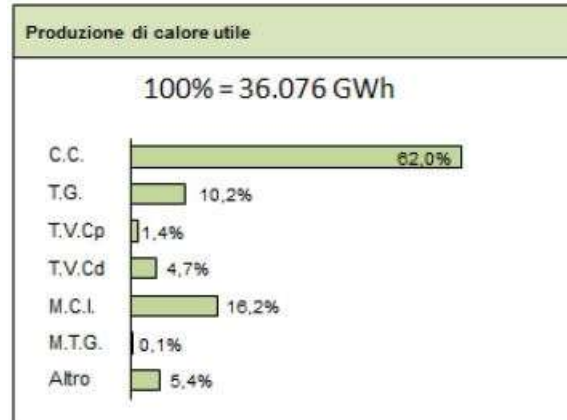
Figura 8 Produzione calore da cogenerazione
