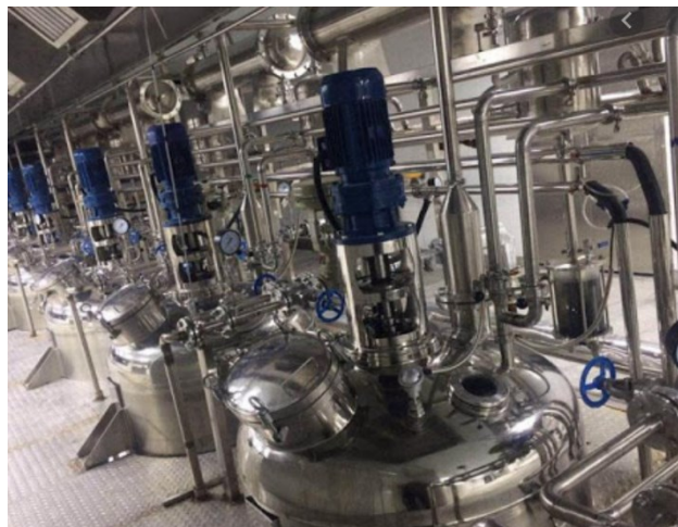
Figura 1.3 - macchinari industriali per l'industria di produzione dei succhi concentrati di agrumi e l'estrazione degli oli essenziali
