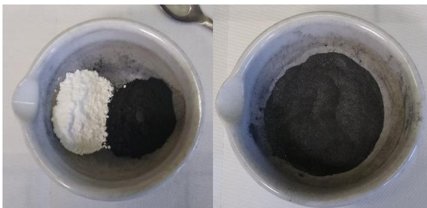
Figura 3.7: Pre-miscelazione manuale delle polveri. In bianco l'ossido di titanio e in grigio scuro la grafite.
