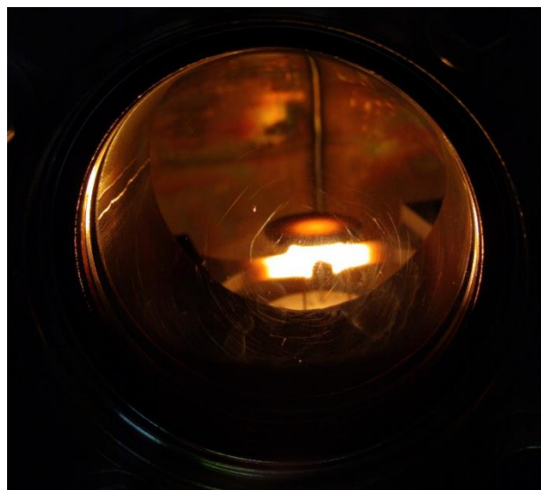
Figura 4.21: Vista interna della camera da vuoto durante l'esecuzione di una misura di conducibilità.
