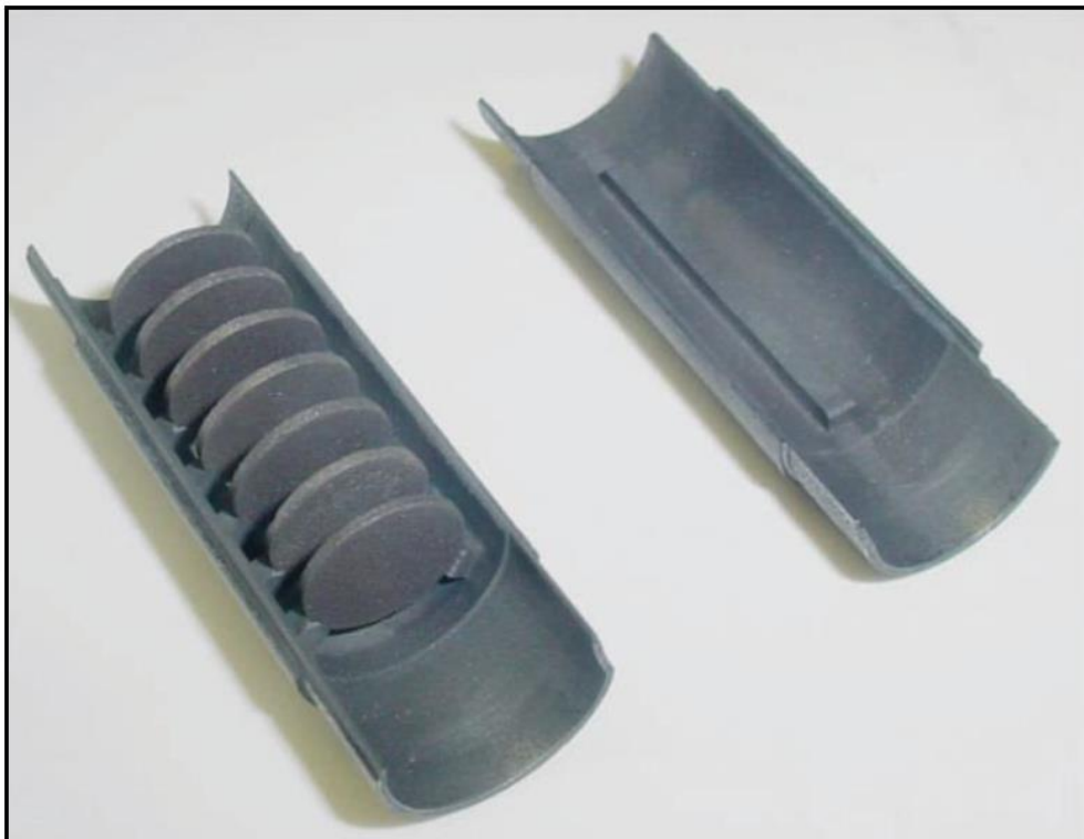
Figura 2.11: 7 dischi in carburo di uranio alloggiati di un primo prototipo di box in grafite dopo che era stato eseguito un test online agli ORNL.
