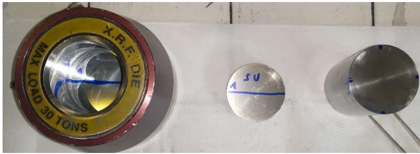
Figura 3.13: Riferimenti sui componenti dello stampo.
