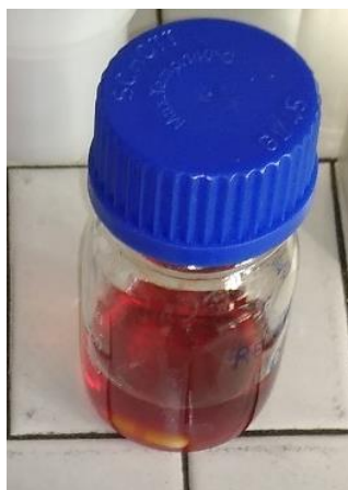
Figura 3.6: Resina fenolica completamente disciolta in acetone, da notare la presenza dell'ancorina dell'agitatore magnetico di colore bianco.
