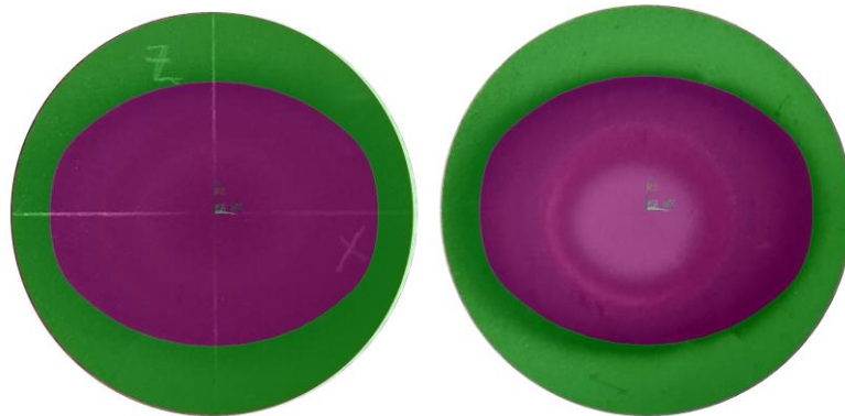
Figura 4.38: Sovrapposizione delle aree del modello FEM con il target.
