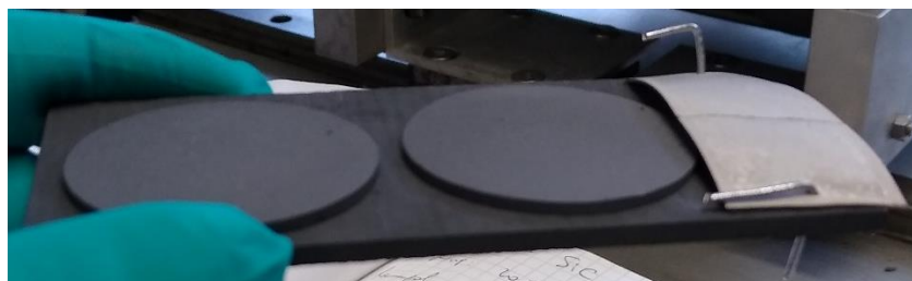
Figura 3.22: Lamina di tantalio installata sul supporto in grafite.
