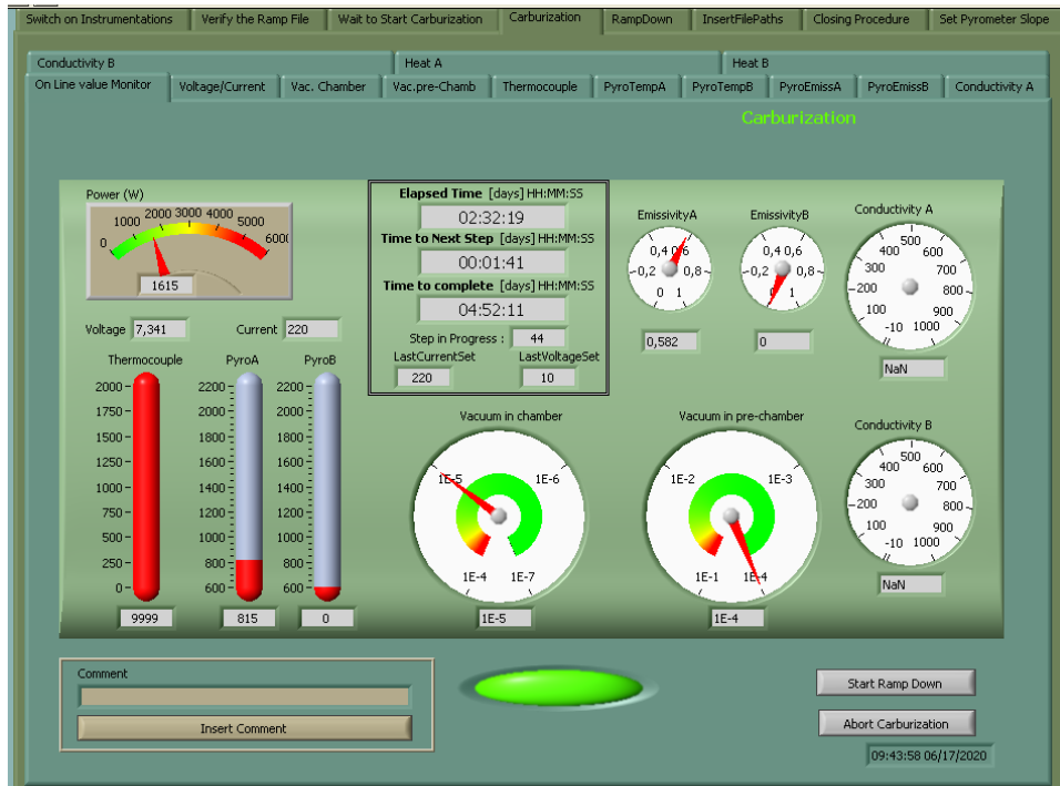
Figura 3.19: Interfaccia grafica utente con il valore dei principali parametri.
