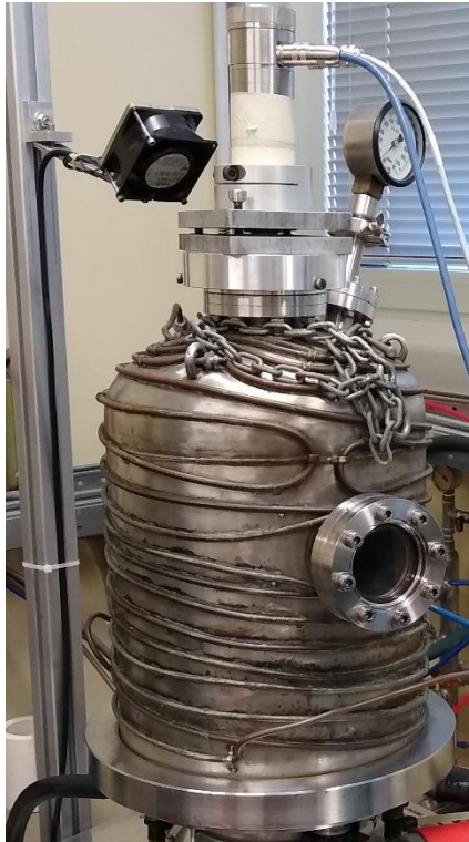
Figura 4.4: Camera da vuoto. Si può osservare uno dei due oblò di ispezione e la serpentina di raffreddamento.
