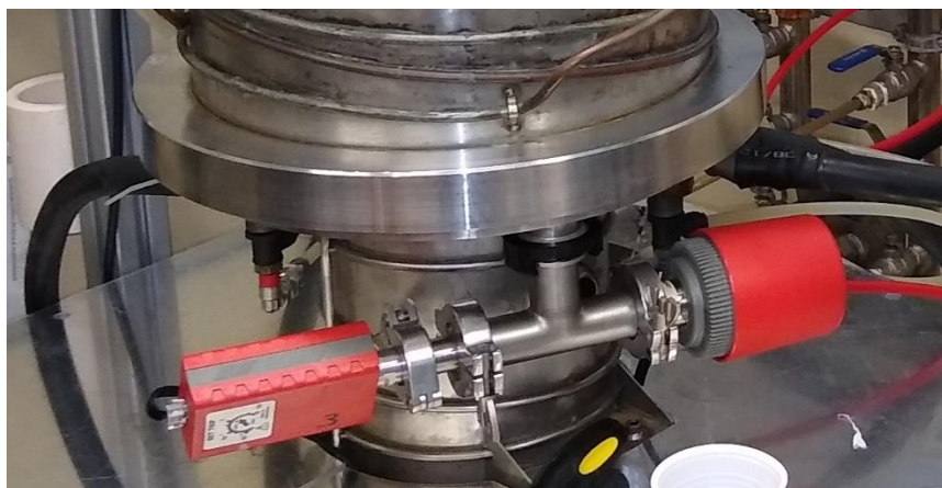
Figura 4.13: Primo piano di un vacuometro collegato ad un condotto della camera.
