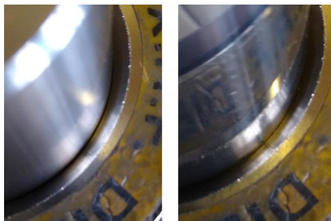
Figura 3.15: Da sinistra verso destra punzone vecchio e punzone nuovo, si può notare una luce minore tra punzone e camicia.
