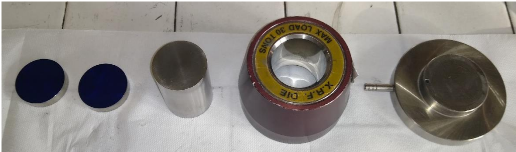
Figura 3.4: Componenti dello stampo, a partire da sinistra: 2 pastiglie, punzone, camicia, base dello stampo.
