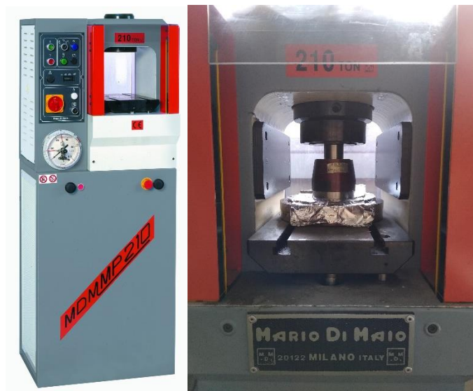
Figura 3.2: Pressa e dettaglio della tavola porta stampi.
