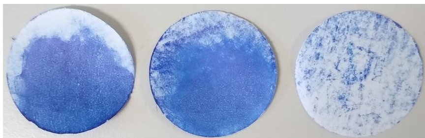
Figura 3.13: Da sinistra a destra progressivo miglioramento della distribuzione della pressione all'aumentare della pulizia della tavola porta stampo.
