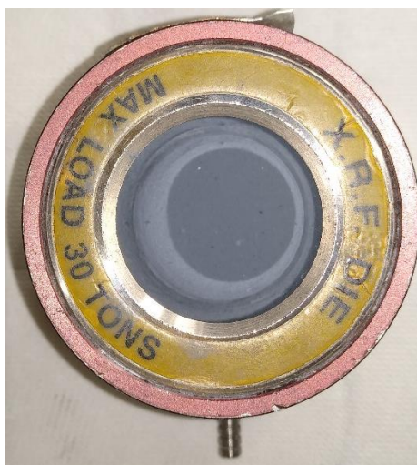
Figura 3.10: Vista dall'alto dello stampo riempito con la polvere distribuita omogeneamente.
