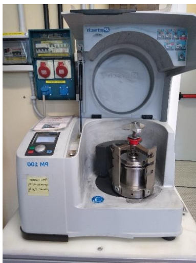
Figura 3.8: Mulino a palle con giara assicurata alla ruota del mulino con il sistema di blocco in dotazione.
