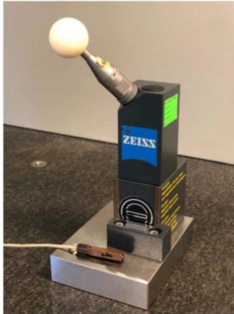
Figura 4.9 Sfera master utilizzata per la qualifica dei tastatori
