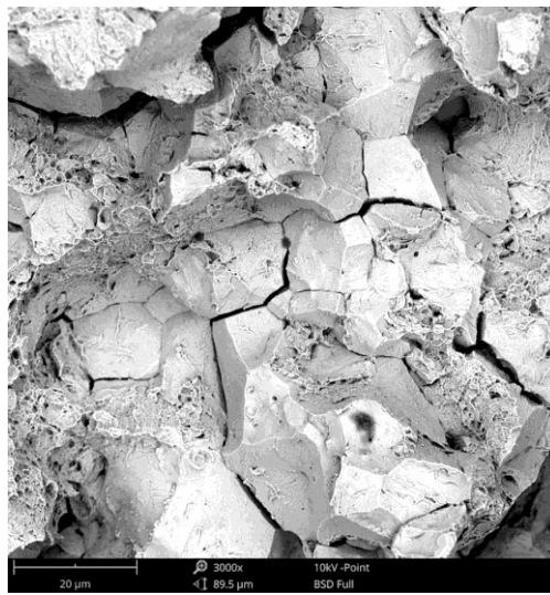
Figura 2.13: immagine al SEM di una superficie di frattura con microcleavage . [10]
