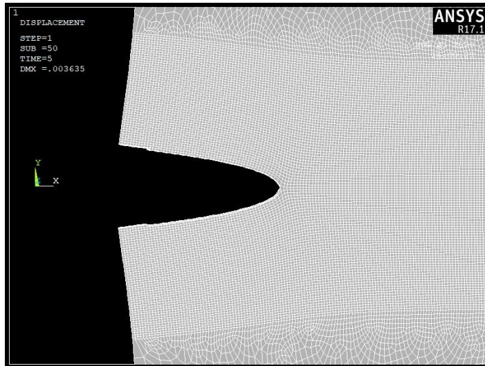
Figura 4.11: deformata del modello al substep 50 ( \Delta T = 5 sec).
