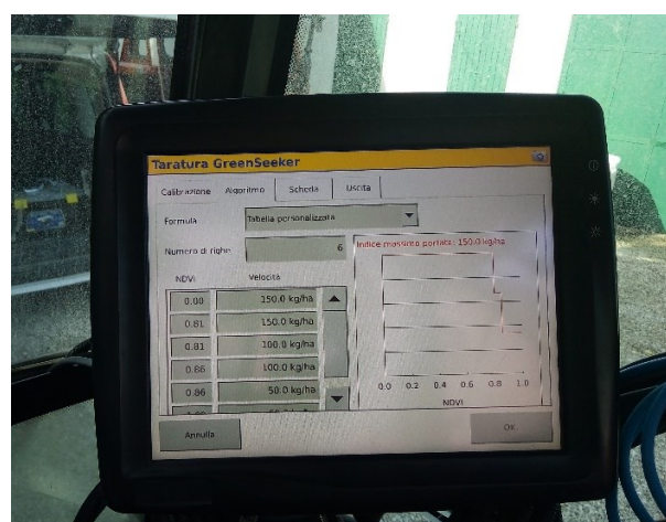
Fig 3.5: In alto, rilievo con GreenSeeker handheld; in basso, inserimento delle soglie nel monitor FM1000
