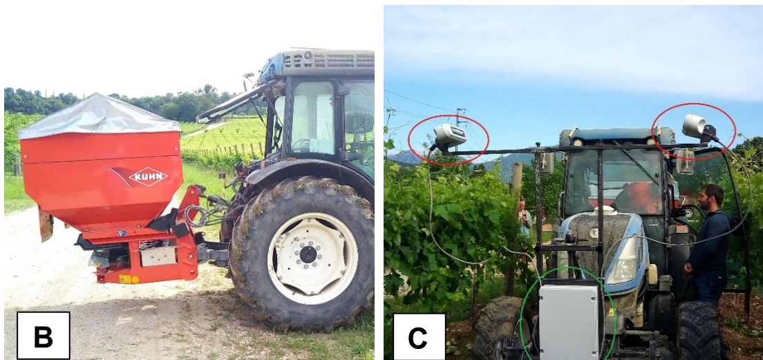
Fig. 3.3: La macchina in configurazione operativa (A), con dettaglio dello spandiconcime (B), dei sensori, cerchiati in rosso e della centralina, in verde (C)
