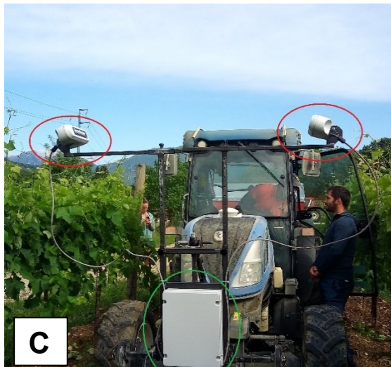
Fig. 3.3: La macchina in configurazione operativa (A), con dettaglio dello spandiconcime (B), dei sensori, cerchiati in rosso e della centralina, in verde (C)
