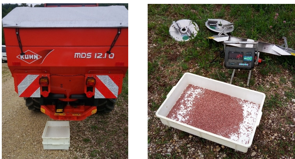
Fig.3.4: Dettaglio della calibrazione dello spandiconcime
