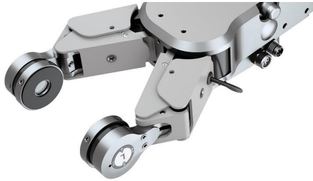
Figura 1.15 Esempio di gripper, in particolare una pinza
