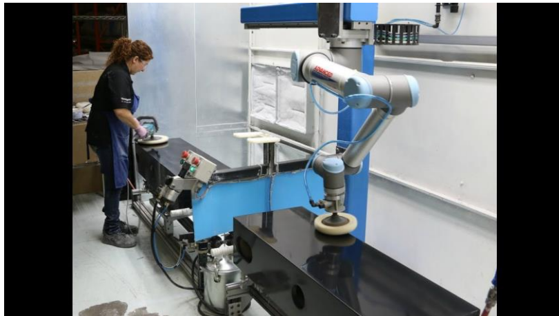
Figura 1.7 Esempio di collaborazione tra operatrice e braccio robotizzato Universal Robots , si nota la totale assenza di barriere fisiche tra persona e robot
