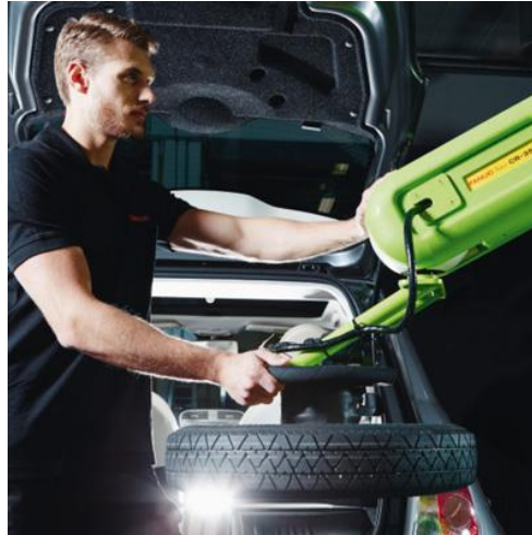
Figura 3.1 cobot Fanuc con dispositivo di guida manuale
