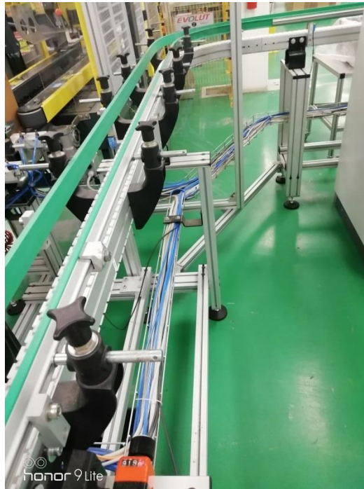
Figura 4.1 Nastro trasportatore che trasferisce i contenitori alla postazione del robot, le sponde verdi evitano che i flaconi cadano durante il tragitto e sono regolabili tramite le manopole nere visibili per adattarsi alle dimensioni dei prodotti che transitano
