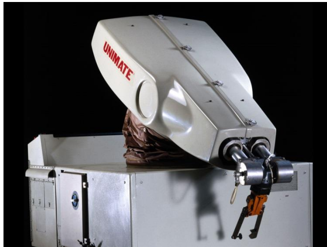
Figura 1.2 Braccio robotizzato Unimate della Unimation
