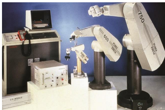
Figura 1.5 Le tre serie dei robot PUMA, ovvero la 200, la 600 e la 750, insieme all'unità di controllo
