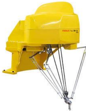
Figura 1.14 Esempio di robot parallelo
