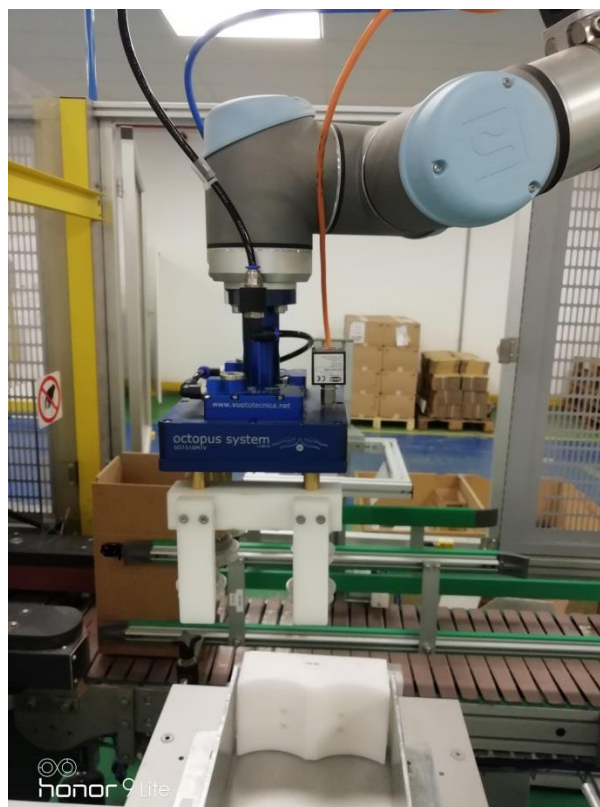
Figura 4. Particolare dell'end effector costituito da sei ventose
