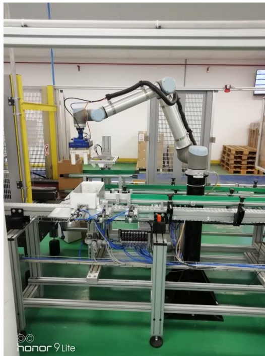
Figura 4.2 Veduta complessiva dell'interno della cella, si possono vedere il robot antropomorfo dotato di ventose, la parte terminale del nastro trasportatore, il box di raccolta dei contenitori e i pistoni che cadenzano i prodotti
