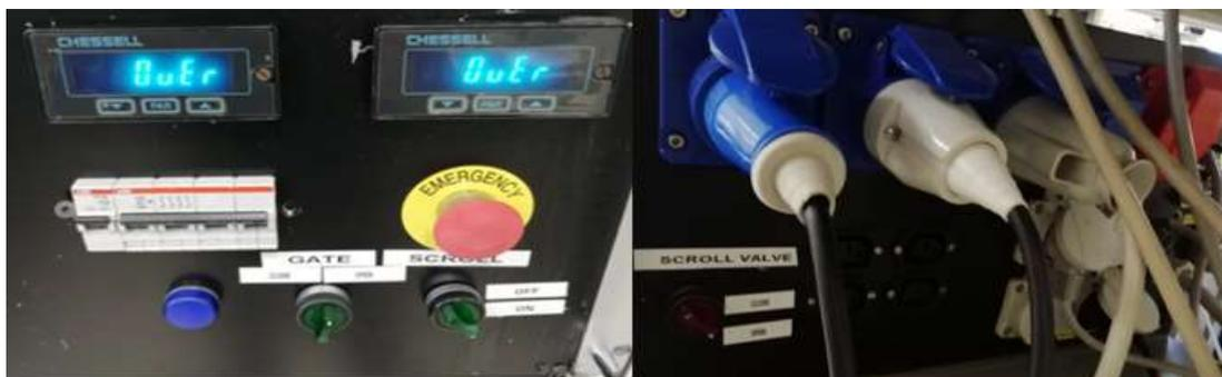
Figura 7-4 Switch necessari all'apertura e chiusura delle valvole e all'accensione della scroll.
