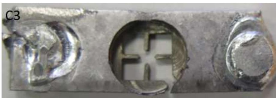
Figure 2 Immagine del campione 3 dopo aver subito processi di fresatura per ricavare campioni di dimensioni minori.
