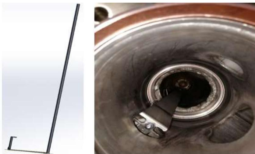
*Figura 7-8 immagine relativa alle staffe in inconel per tenere le termocoppie ancorate alla parete della camera principale. A sinistra disegno finale delle tre sezioni collegate, a destra immagine dove si può vedere la parte finale della staffa che si tuffa nella camera e mantiene ancorate le termocoppie. Per rimuovere il crogiolo è necessario prima rimuovere tale staffa.*
