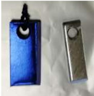
Figura 7-17 Campione a sinistra successivo alla BCP ed al processo di anodizzazione 20V per 5 minuti. Campione a destra immediatamente successivo a 10minuti di BCP soluzione 1:1:2.
