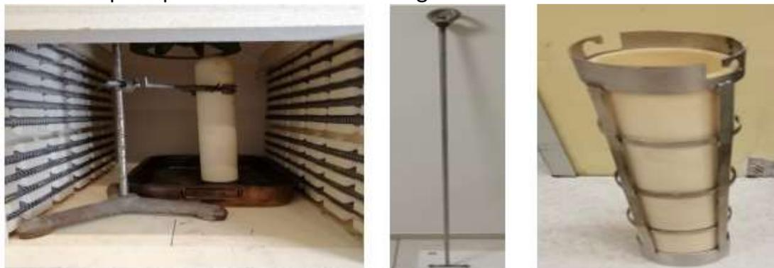
Figura 7-13 Metodologia adottata per lo svuotamento dello stagno residuo nel crogiolo.
