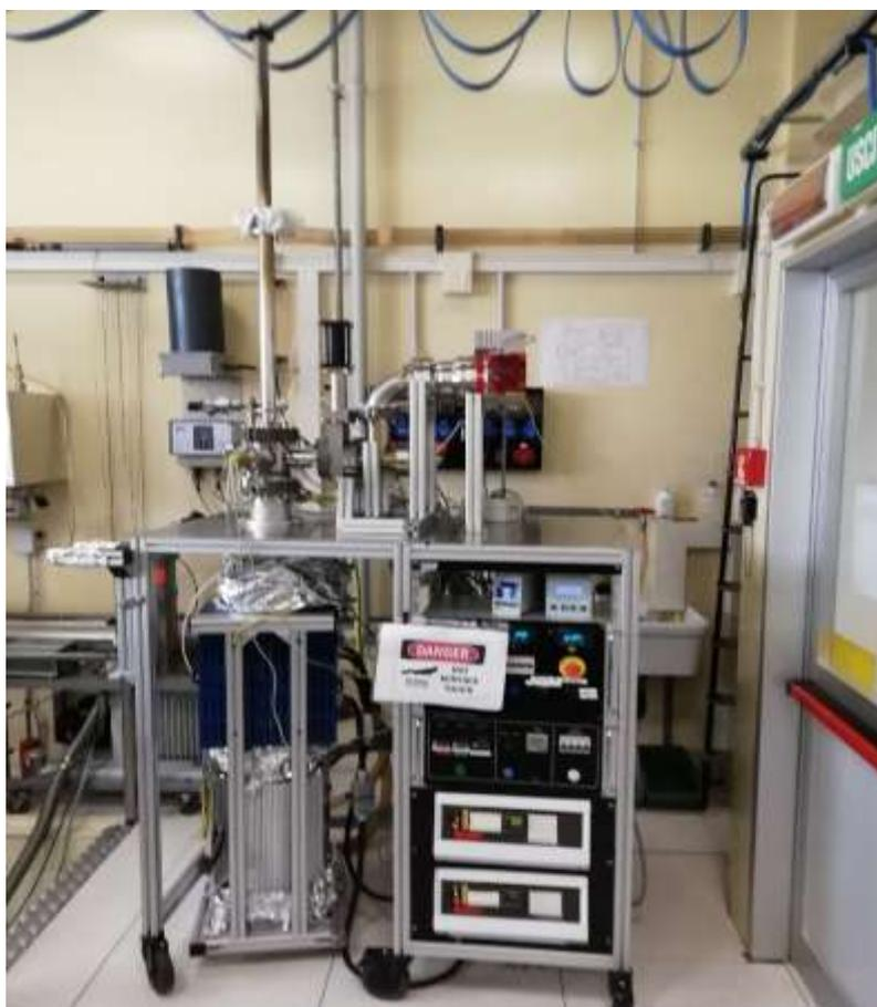
Figura 7-2 Sistema per dipping LTD sviluppato per la creazione di target e ricoprimenti in  $Nb_3Sn$ .
