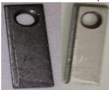
Figura 7-16 Campioni Nb 3mm prima e dopo il lavaggio in ultrasuoni.
