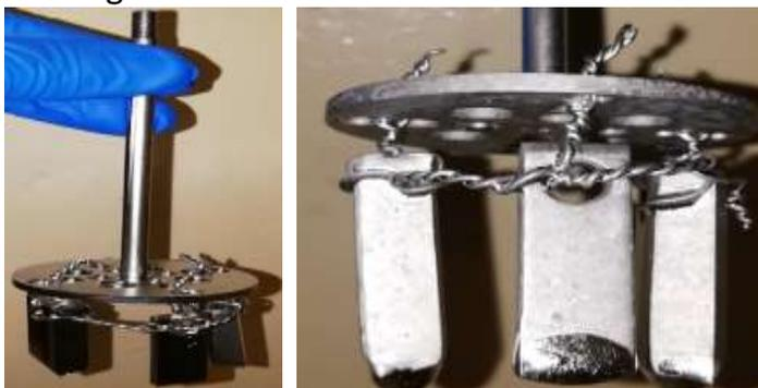
Figura 7-15 Sinistra immagine relativa al posizionamento di tre campioni sul supporto per dipping e successivo annealing. Destra campioni relativi al primo processo dopo l'estrazione dalla camera.
