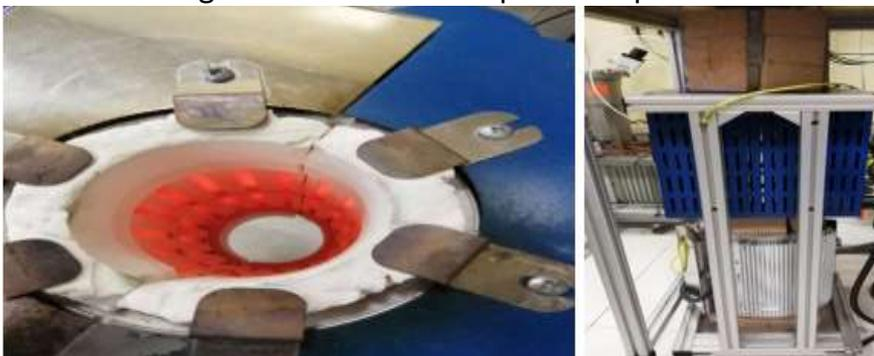
Figura 7-7 A sinistra fornace upper che opera all'aria. Destra fornace upper (blu) e lower(bianca) nella configurazione per il dipping; le parti scoperte della camera in inconel vengono schermate con mattoni refrattari per permettere un miglior mantenimento della temperatura.
