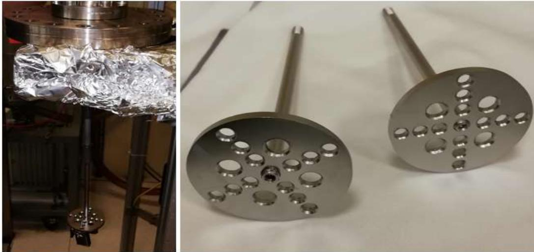
Figura 7-6 Immagine a sinistra relativa al manipolatore completo di portacampione, immagine a destra relativa al supporto dei campioni. I numerosi fori consentono allo stagno fuso di attraversare il portacampione evitando l'effetto pistone. A destra si osserva il manipolatore su cui è installato il supporto in niobio.
