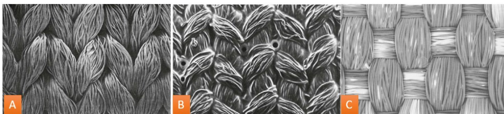
Figura 3.6. Tessitura del Dacron. (A) Knitted warp . (B) Knitted weft . (C) Woven
